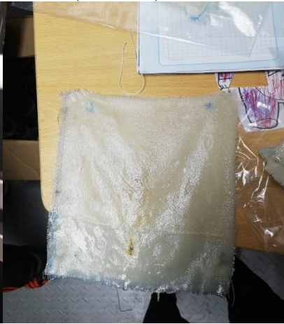
Resistencia a la llama por el textil técnico de 2 capas con resina (60/40 %)
