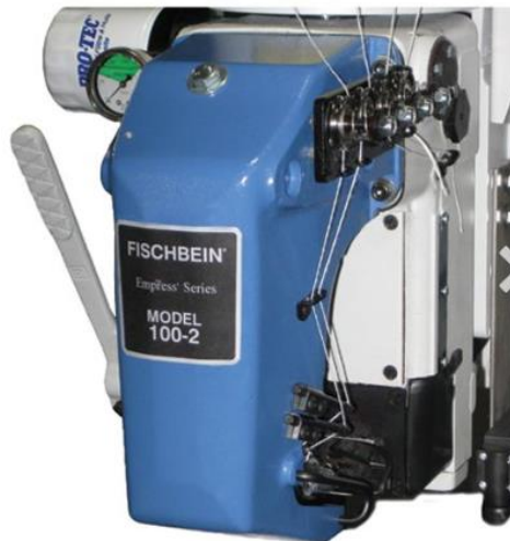
Figura 35 Cabezal de costura sencilla modelo 100-2 [35]
