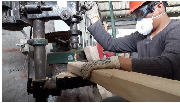
Ensayo de taladrado.
