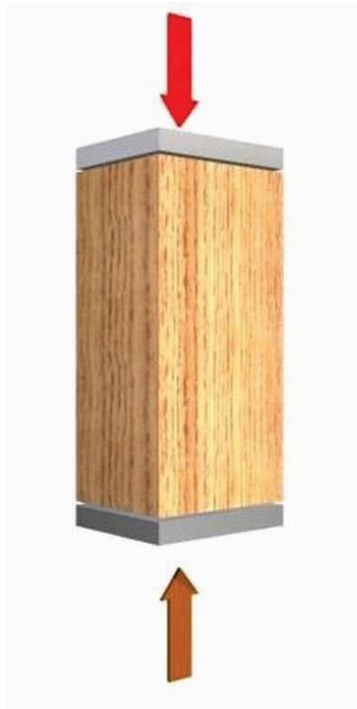
Figura 5. Ensayo de Compresión Paralela a la Fibra. Fuente: CORMA, (2011).
