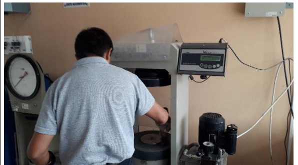
Limpieza y calibración de prensa hidráulica.
