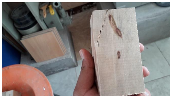
Punto de ruptura y fallo de la madera.
