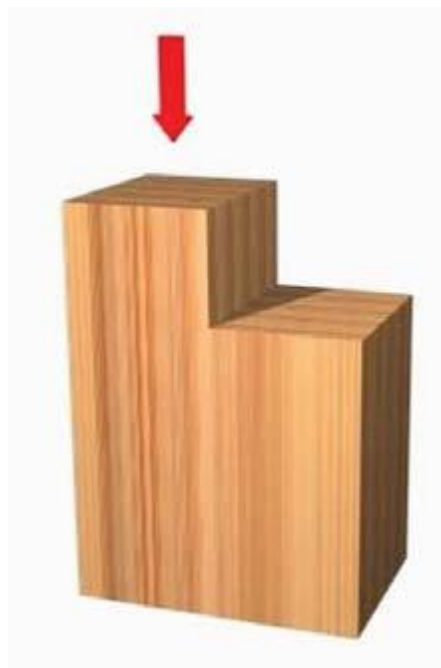
Figura 7. Ensayo de Cizallamiento o Cizalle. Fuente: CORMA, (2011).
