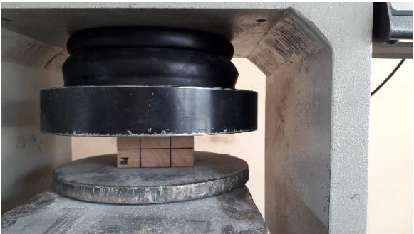
Ensayo de compresión perpendicular.
