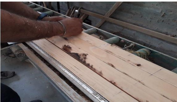
Transformación de bloque a probetas.
