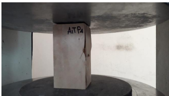
Ensayo de compresión paralela.
