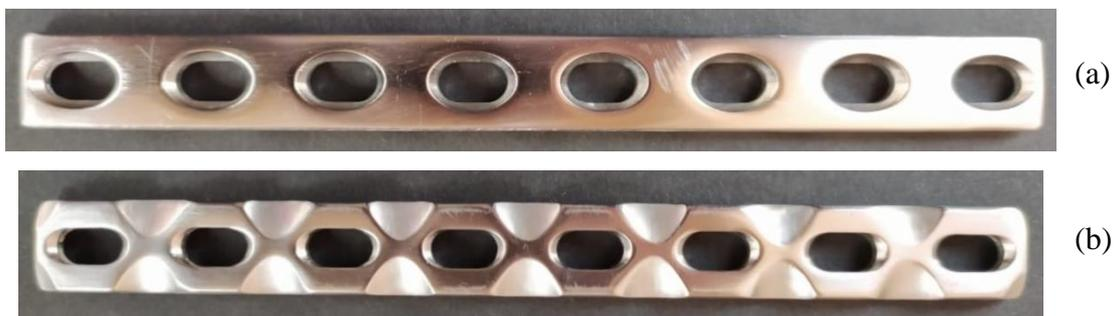
*Figura 4.49 Placa LC-DCP con pulido comercial; (a) Superficie superior, (b) Superficie inferior*
