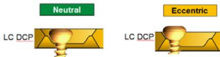
*Figura 2.16 Posición neutral y excéntrica del tornillo en una placa LC-DCP [38].*
