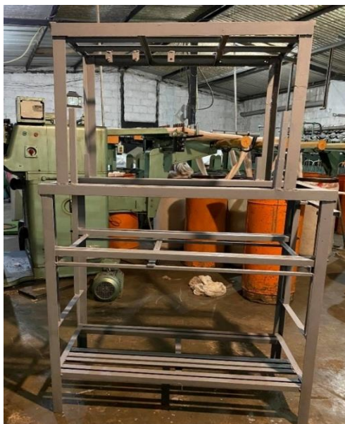
Anexo 2. A. Estructura de perchadora de hilo con anticorrosivo.
