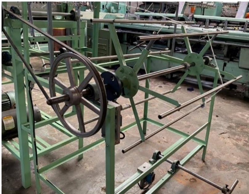
Anexo 11. A. Montaje de componentes de la madejadora.
