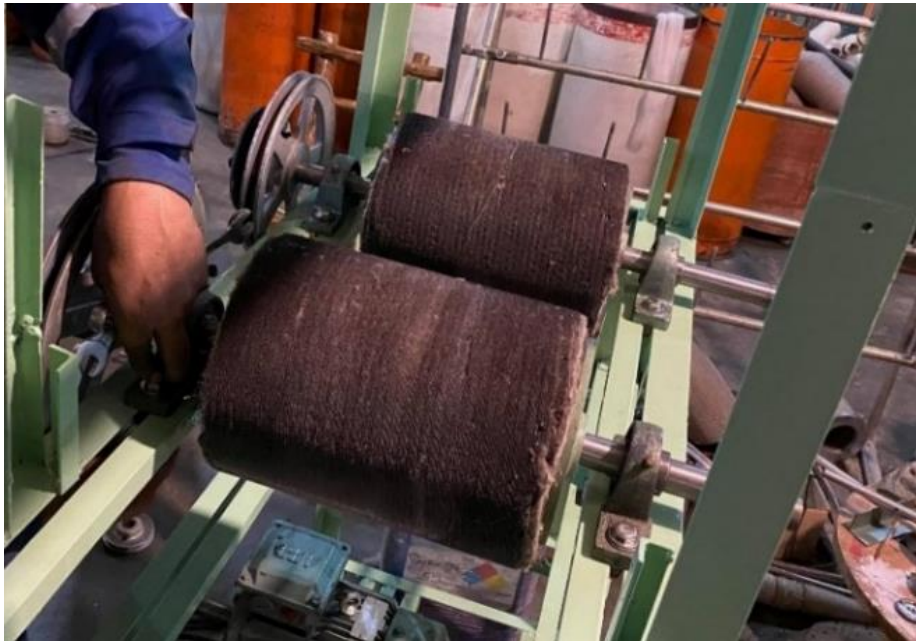
Anexo 4. A. Montaje de cilindros perchadores.
