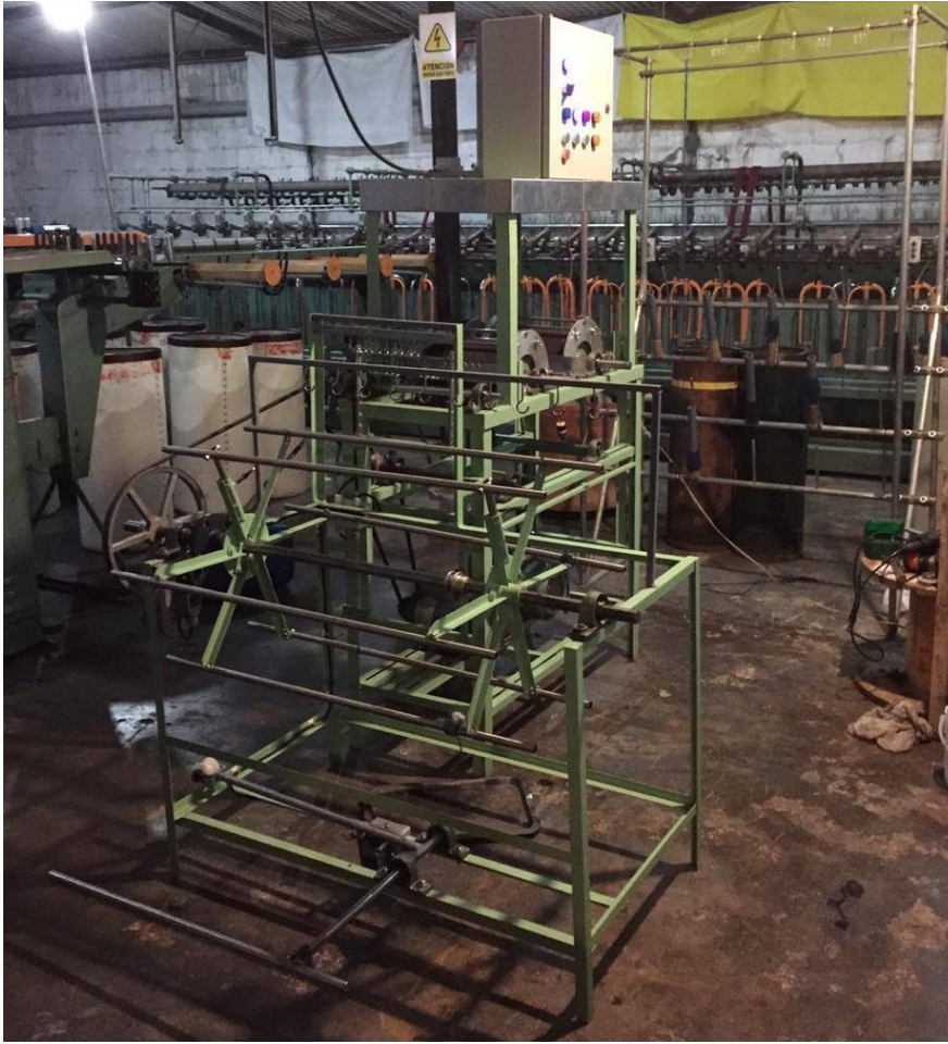
Anexo 12. A. Ensamblaje máquina perchadora de hilo.
