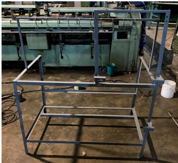
Anexo 9. A. Estructura de la madejadora colocada anti corrosivo.
