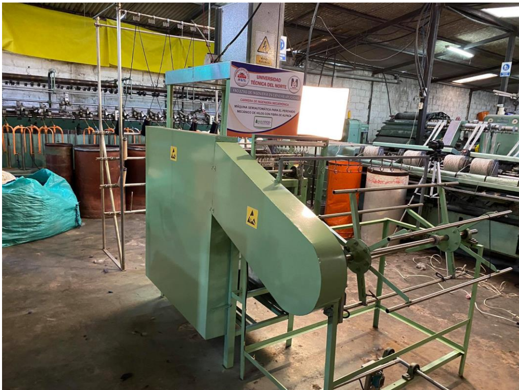
Anexo 15. A. Colocación de tapas en el sistema de transmisión de movimiento.
