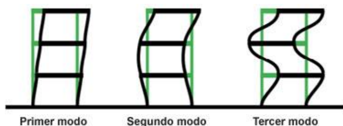
Figura 22: Modos de vibración de un edificio.
