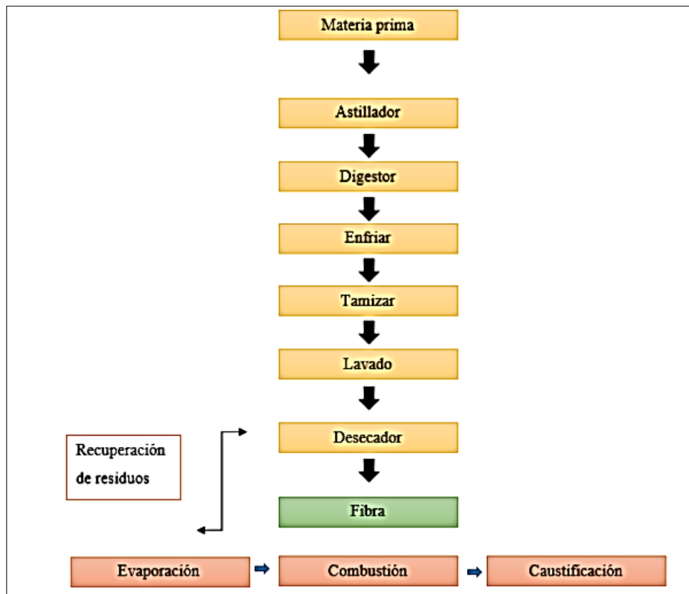
Figura 9. Proceso de obtención de la fibra de bambú
