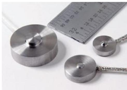
Figura 8: Celda de carga [25]
