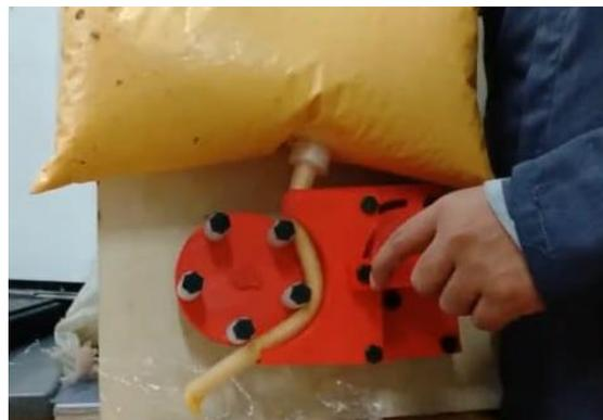
*Figura 19: Simulación prototipo dosificador de queso Cheddar líquido.*
