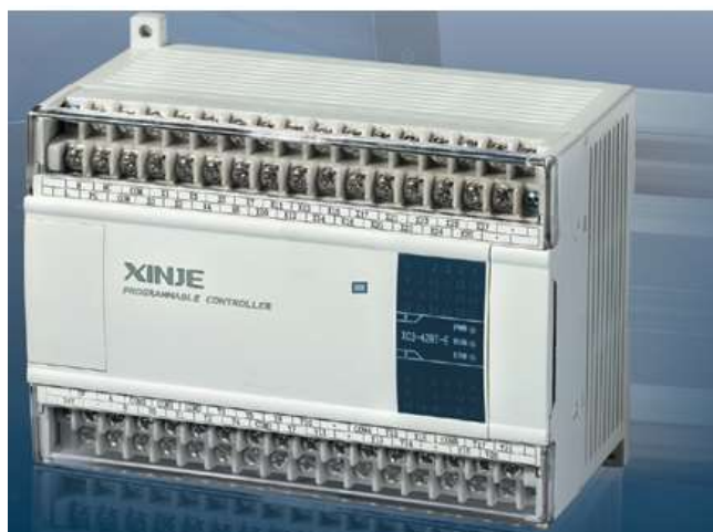
Figura 13: Controlador lógico programable (PLC) [32]
