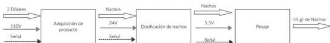
Figura 19: Diagrama de análisis funcional nivel 1
