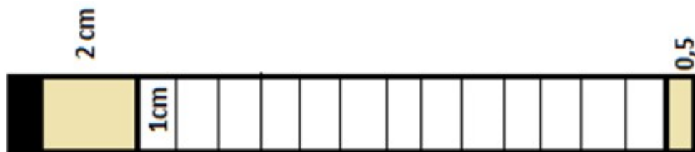
Figura 20. Señalización de la muestra para la prueba de absorción de humedad vertical
