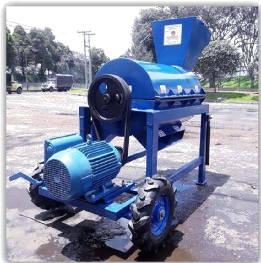
Figura 19. Desfibradora de coco Koyote Agroindustrial 7.5hp - 10hp (eléctrico-diesel) Fuente: https://www.olx.com.co/item/desfibradora-coco-maquina-para-fibra-coco-extractora-fibra-de-coco-iid-1065039161
