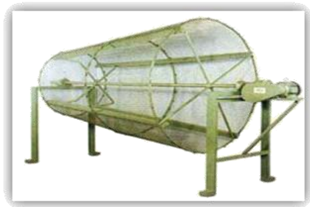
Figura 17. Máquina cribadora para separar fibras cortas y largas de coco Fuente: (Alas, 2010, p.64)
