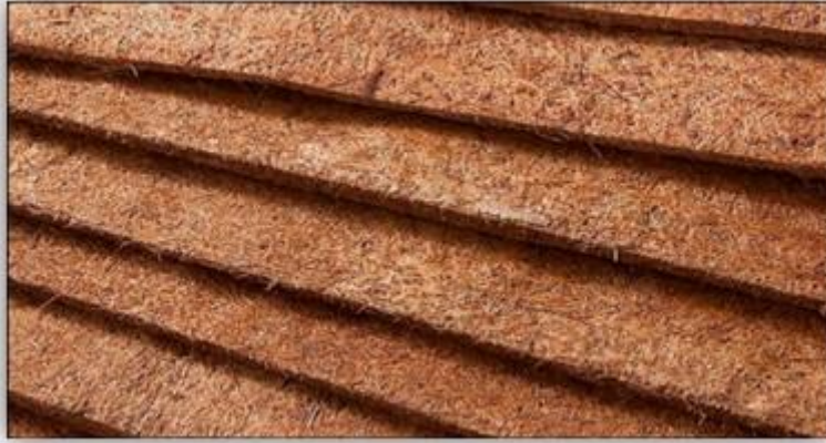
Figura 2. Panel de fibra de coco para losa de hormigón Fuente: (Isolamentos S.A., 2018)
