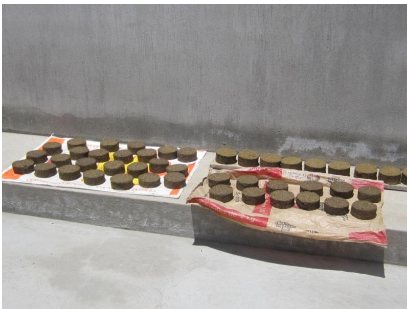
Figura 7. Secado de los bloques (27°C)
