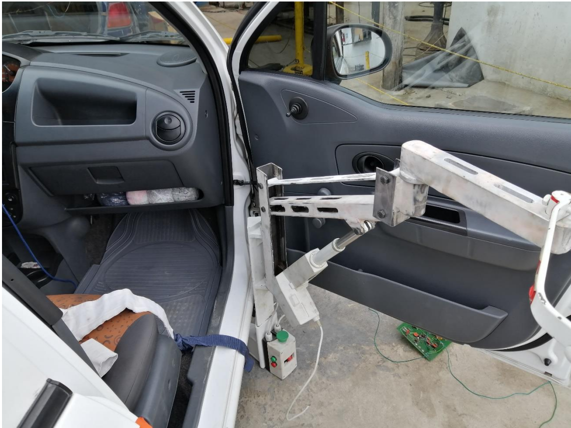
Figura 3.19 Dispositivo de traslado ensamblado y enganchado al vehículo correctamente.
