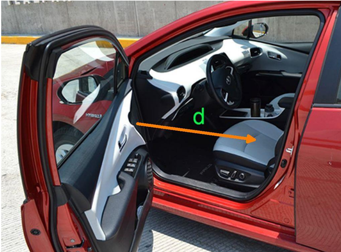
Figura 2.2. Distancia desde la articulación de la puerta hasta el centro del asiento del vehículo.
