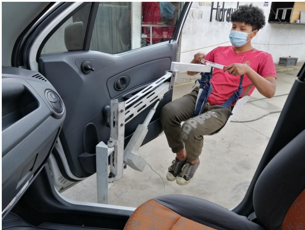
Figura 3.20 Usuario con arnés enganchada al dispositivo de traslado en la posición uno.
