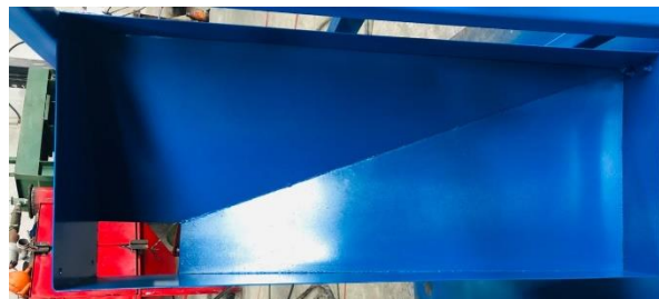
Fig. 4.9 Construcción de la tolva de salida
