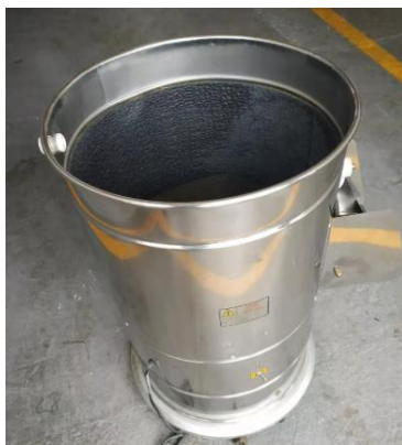
Fig. 3.3 Máquina peladora con cámara de paredes abrasivas
