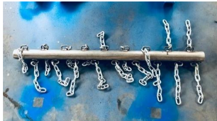
Fig. 4.10 Eje con soldadura de cadenas
