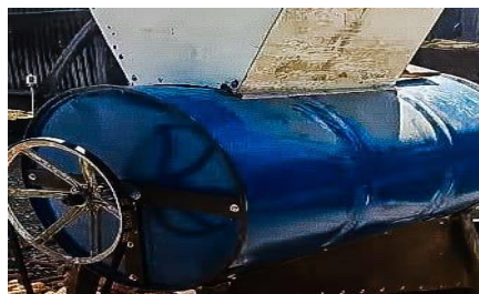
Fig. 3.7 Máquina de cilindro reforzado y eje con cadenas giratorias.
