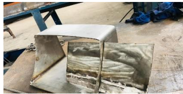
Fig. 4.8 Construcción de la salida de semilla de tagua
