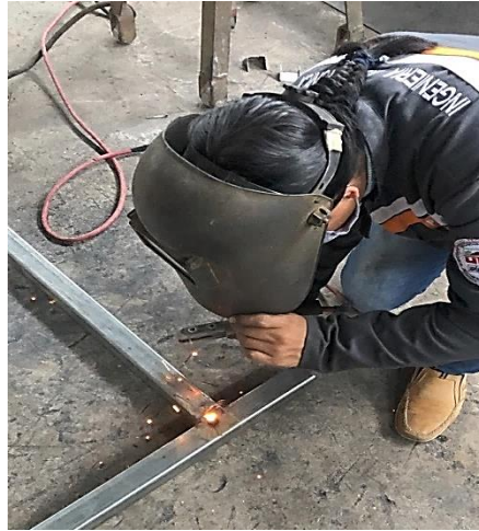
Fig. 4.3 Suelda de la estructura de la máquina.
