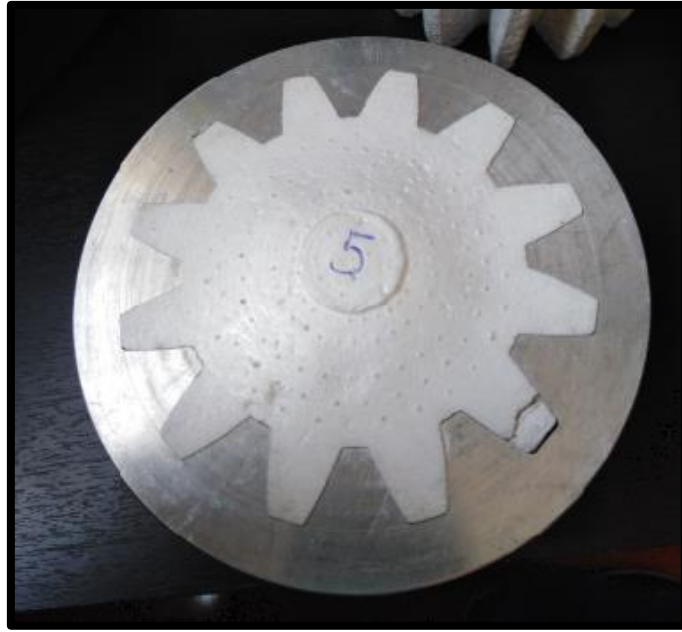
Anexo 7. A. Pieza en EPS dentro del molde.
