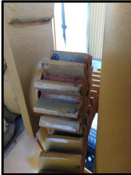
Figura 23. Piñón cónico de la concretora construido en las Industrias Metálicas Ibarra (INDUMEI).
