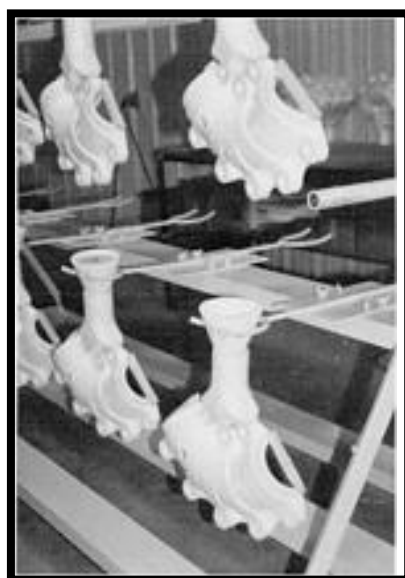
Figura 11 Modelos en EPS acoplados para cubrir con cerámica. Fuente: [16].
