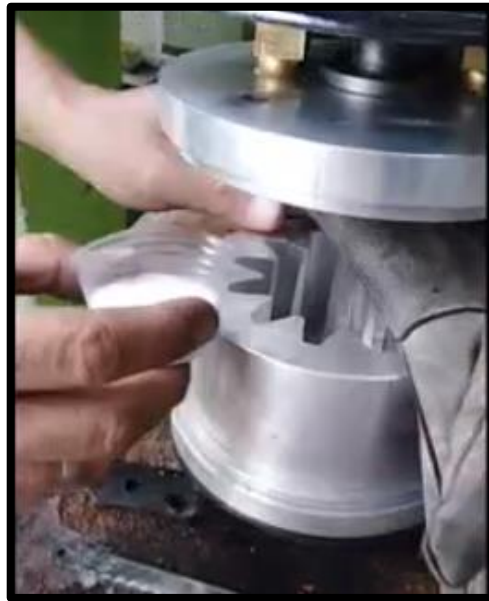
Figura 49. Llenado del molde con perlas de EPS.
