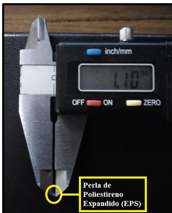
Figura 20. Medida en milímetros de una perla de EPS.
