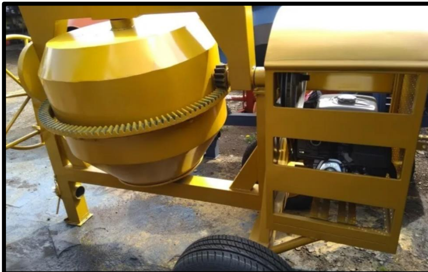
Figura 22. Concretera construida en la industria INDUMEI. Fuente: [19].
