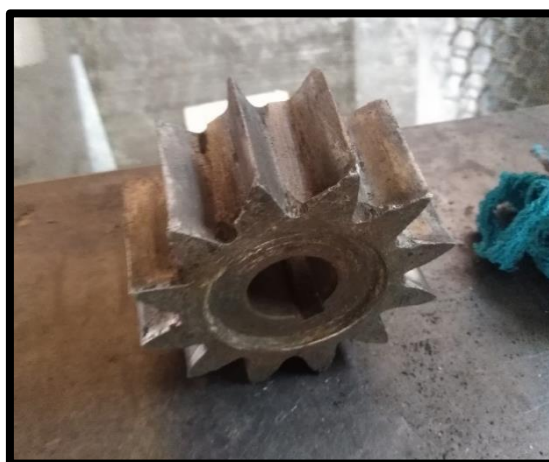
Figura 25 Piñón cónico de concretetera con dientes desgastados.
