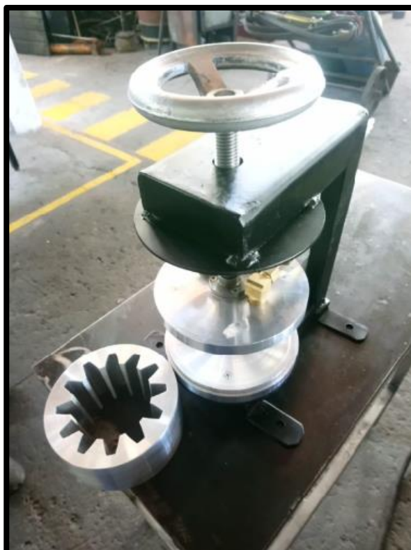
Anexo 6. A. Autoclave para expansión de poliestireno en molde de piñón cónico.
