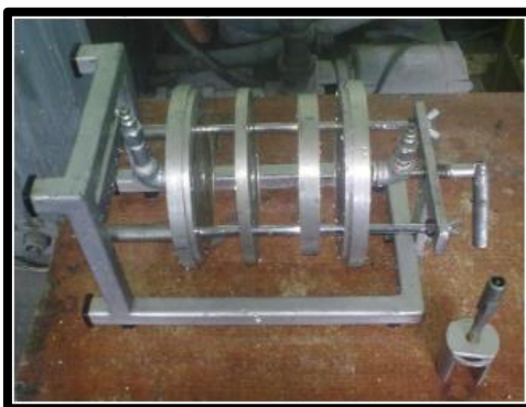
Figura 29. Prototipo experimental de matriz y estructura para fabricación de piezas en EPS.
