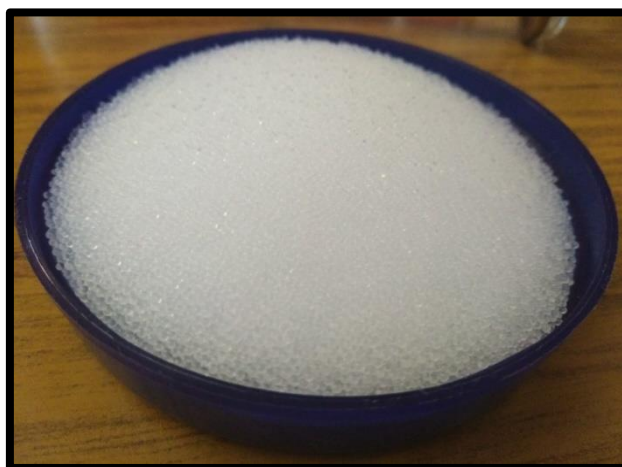
Figura 21 Poliestireno Expandido con un grado de perla T y una densidad de 18 a 22 \text{ kg/m}^3 .
