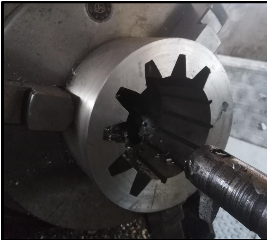
Anexo 1. A. Fabricación del molde de piñón cónico.
