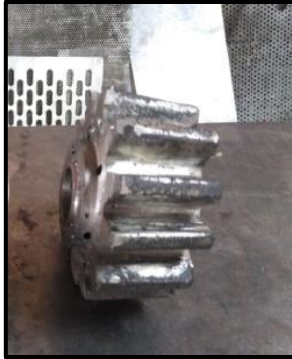
Anexo 3. A. Piñón cónico de concretera elaborado por un proceso de fundición convencional.
