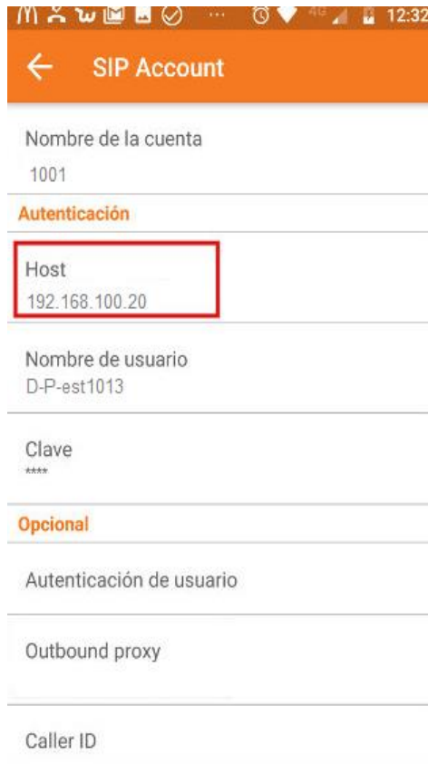
Fig. 45. ingreso de la dirección de la central telefónica.
