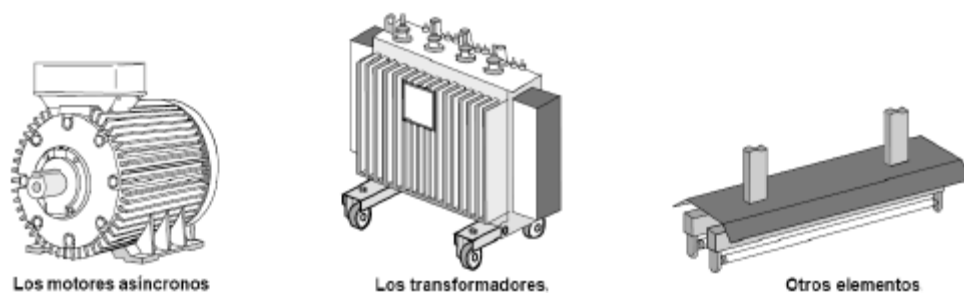
Figura 6. Receptores consumidores de energía reactiva
