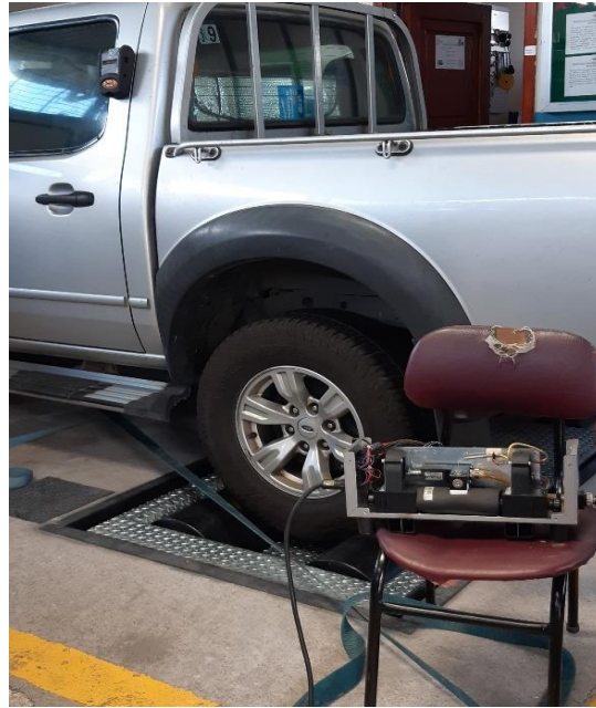
Figura 2.11 Instalación del opacímetro
