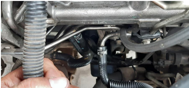
Figura 2.7 Mangueras de entrada y retorno a la bomba de alta presión
