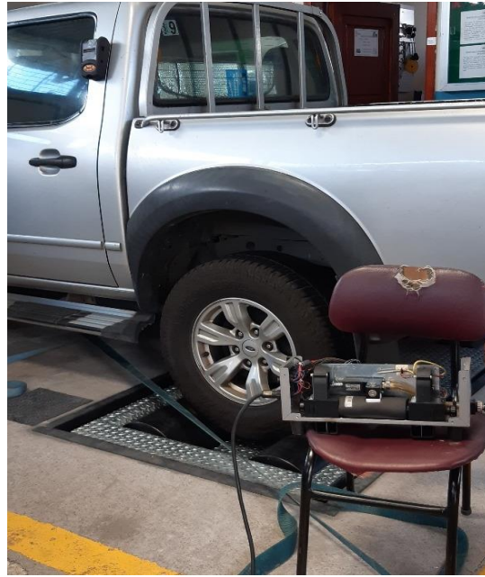
Figura AIV.1 Realización de las pruebas de opacidad
