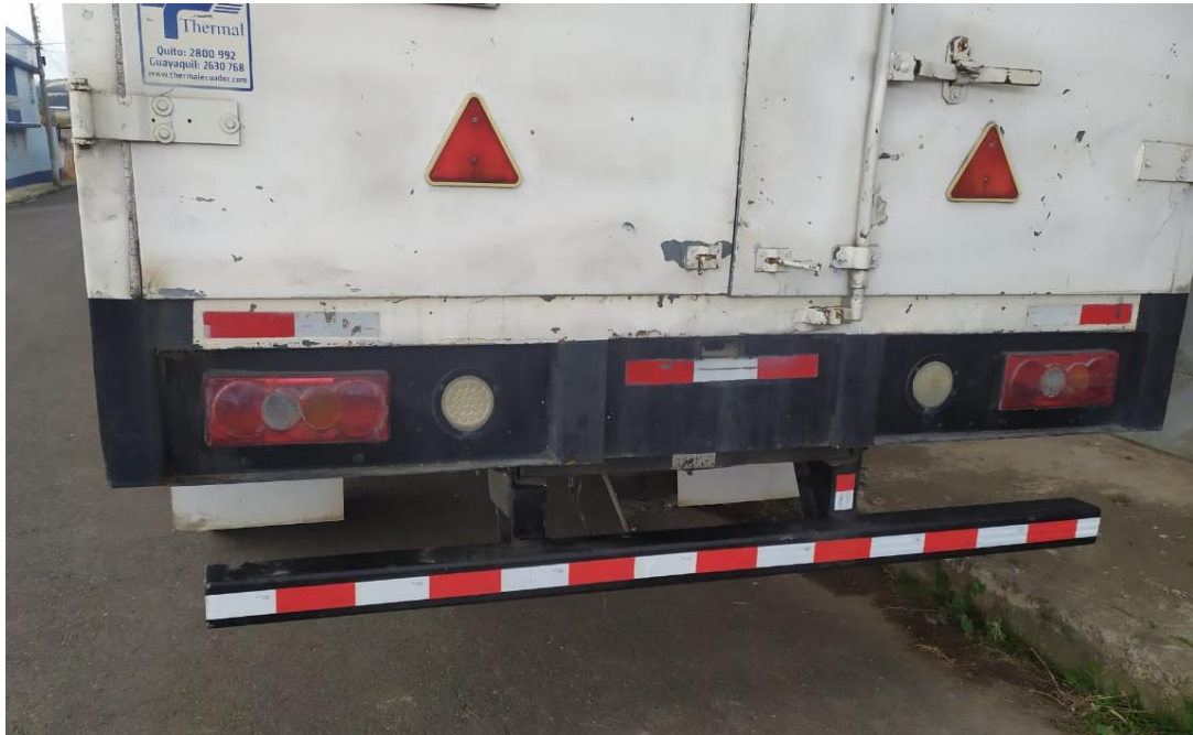
Figura 4.36 Estructura antiempotramiento montada
