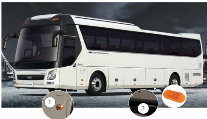
1. Luz indicadora de dirección/ estacionamiento 2. Luces de posición
