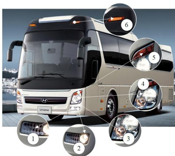
1. Luz de circulación diurna 2. Luz antiniebla 3. Luz de cruce 4. Luz de carretera 5. Luz indicadora de dirección/estacionamiento 6. Luz de gálibo
