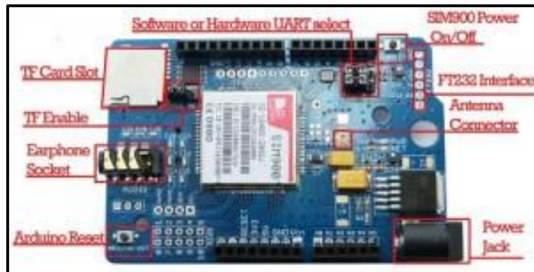
Figura 25 Diseño y distribución de elementos del módulo GSM/GPRS SIM900
