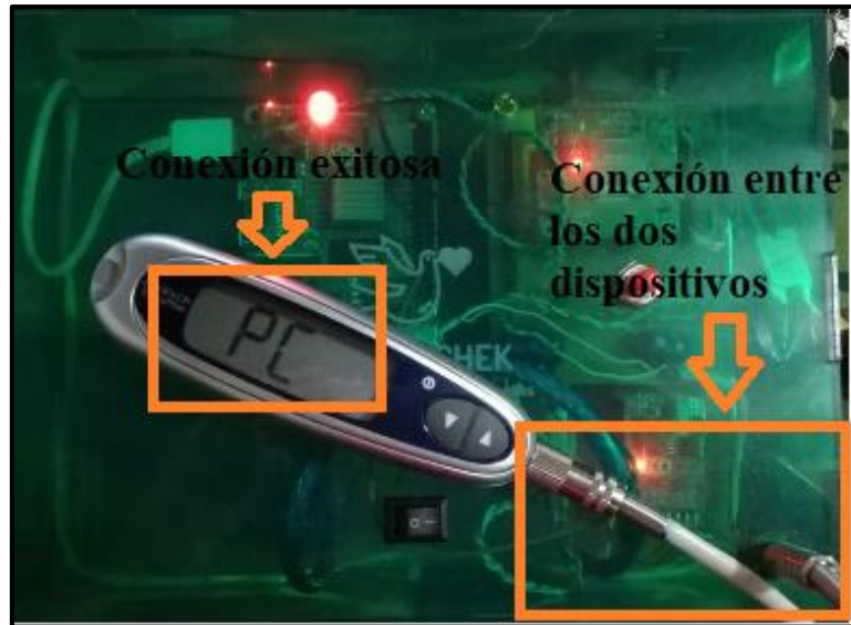
Figura 71 Verificación del estado de conexión entre el glucómetro y el dispositivo Pigeon-Chek
