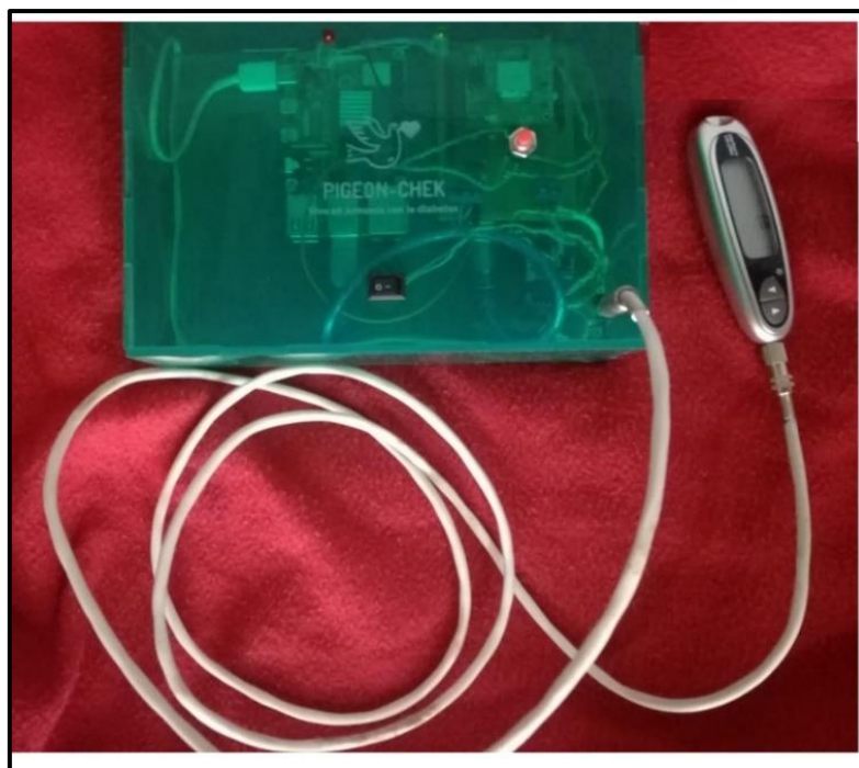
Figura 69 Sistema electrónico para el monitoreo de los niveles de glucosa en la sangre de pacientes diabéticos y la predicción de la hiperglucemia e hipoglucemia síntomas previos al coma diabético
