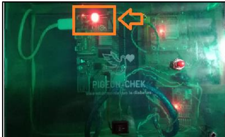
Figura 70 Verificación del encendido del sistema, led indicador rojo encendido
