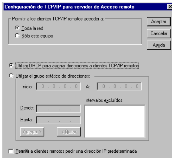
Figura E El cuadro de diálogo Configuración de TCP/IP para servidor de acceso remoto le permite configurar TCP/IP y controlar el comportamiento de la conexión.
