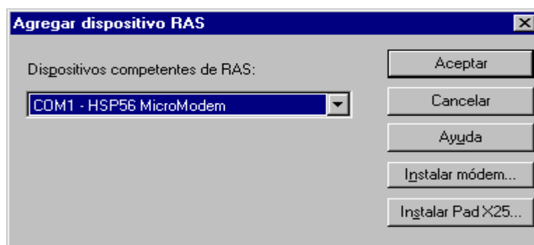
Figura A Cuadro de diálogo de agregar dispositivo RAS le pregunta qué dispositivo de comunicaciones debe usar RAS.
