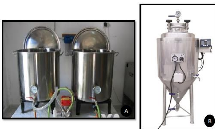
Figura 5. Biorreactores (Contreras R. , 2015) A) Biorreactor artesanal y B) Biorreactor industrial.
