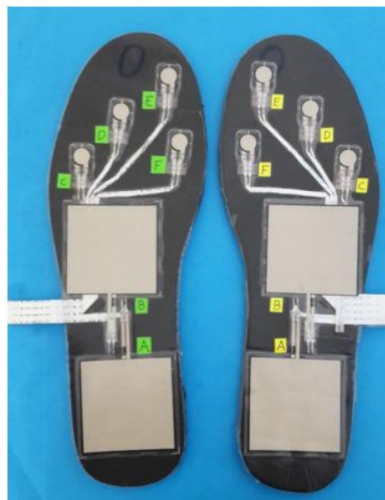
Figura 1.12 Plantilla de zapato fijado sensores TEKSCAN [26]
