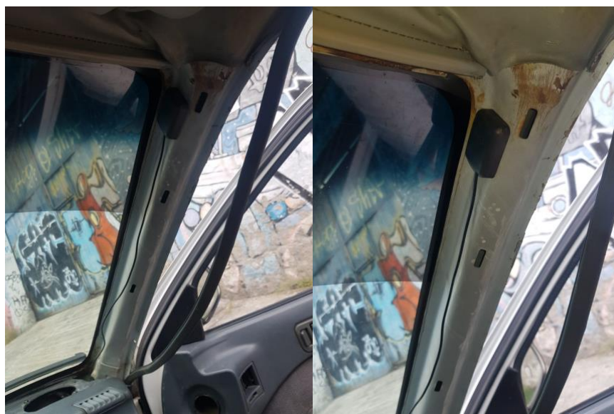
Figura 3.25 Montaje antena GPS
