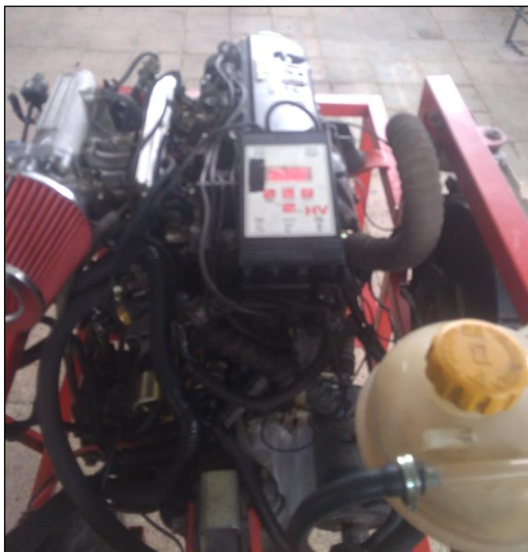
Figura AVII.5 Instalación completa del motor reparado
