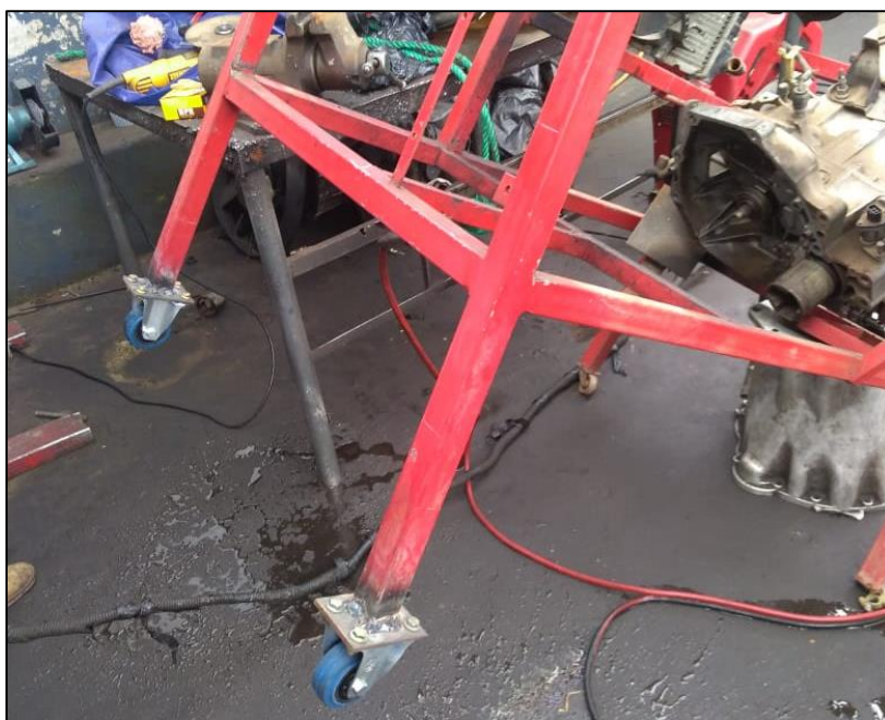
Figura AVII.3 Instalación de ruedas nuevas
