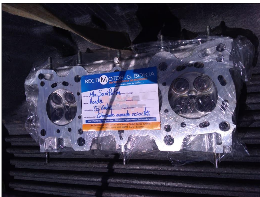
Figura AV.4 Culata realizada su rectificación
