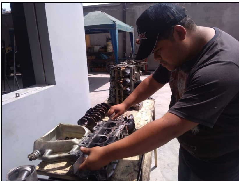
Figura AV.3 Midiendo planicidad en la culata
