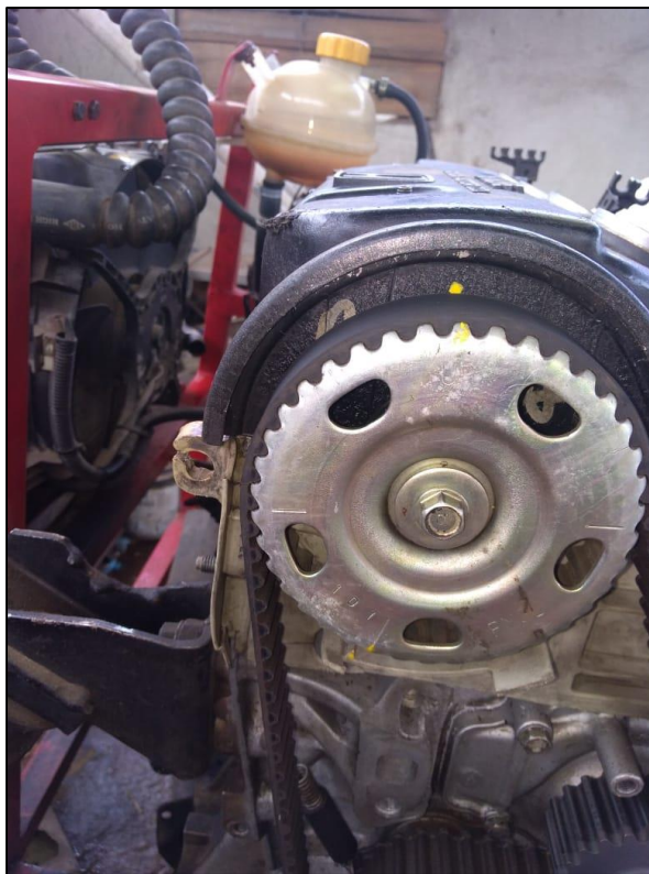
Figura AIV.2 Puesta a punto de la distribución
