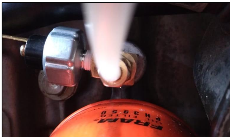
Figura 2.3 Instalación de tubería “T” en el motor
