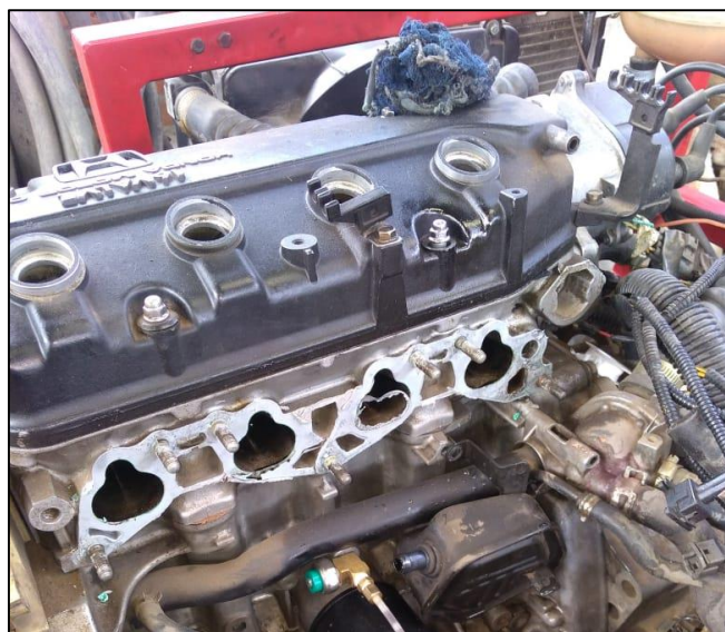
Figura AIV.1 Desmontaje del colector de admisión
