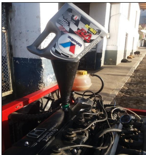
Figura 2.4 Colocación del aceite 10W30
