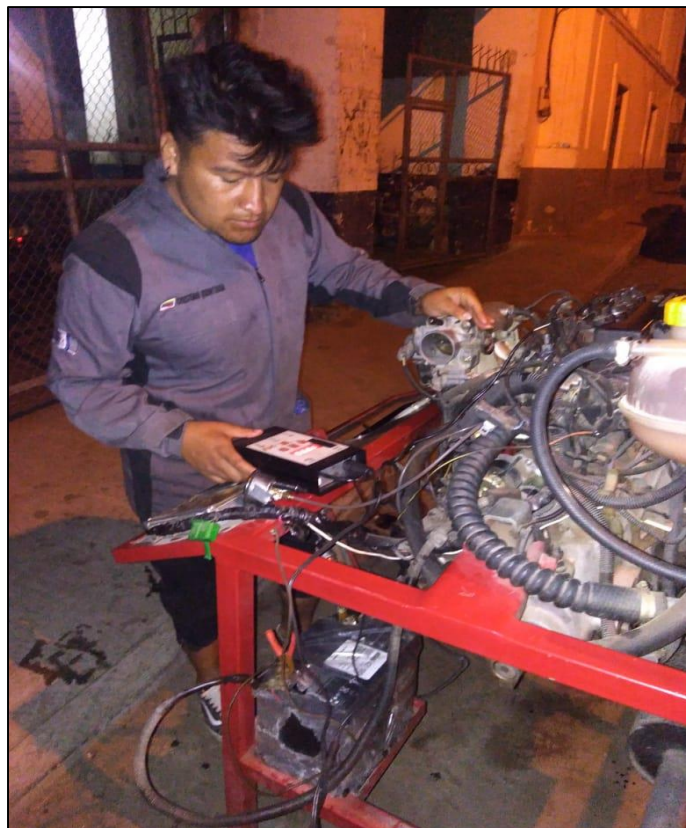
Figura AIII.3 Revisión del régimen de funcionamiento
