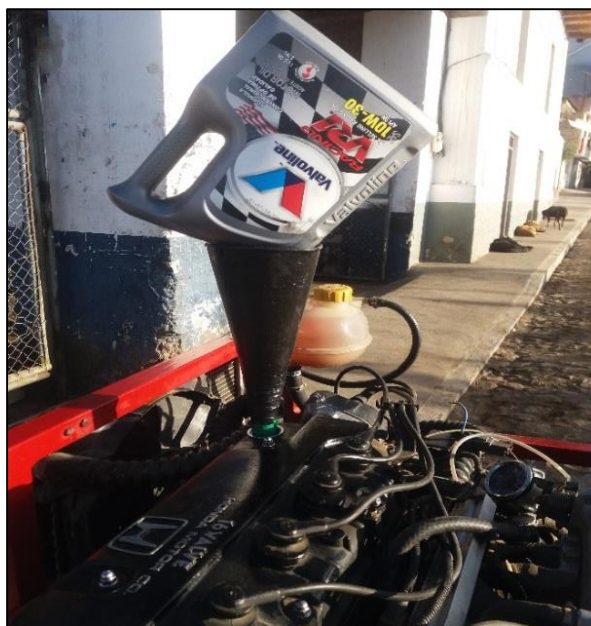
Figura 2. 7 Colocación del aceite 10W30
