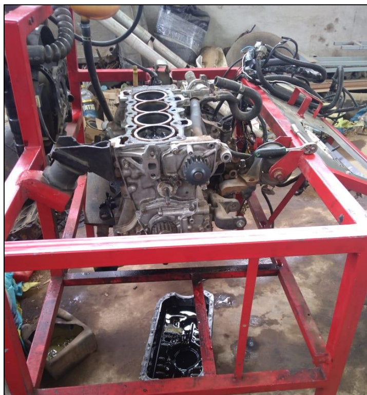
Figura AIV.3 Desmontaje de la culata del motor
