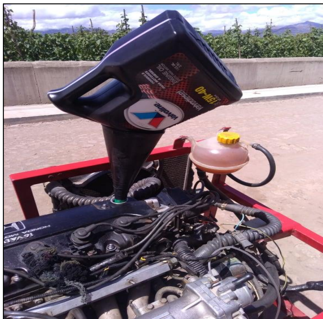
Figura 2.8 Colocación del aceite 15W-40
