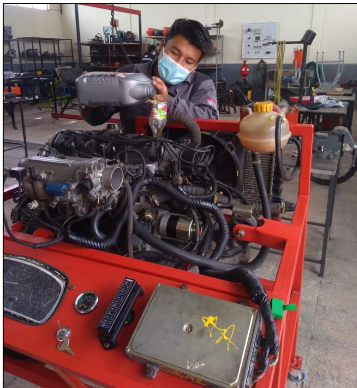
Figura AVIII.1 Colocación de aceite lubricante
