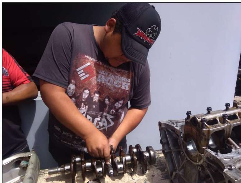
Figura AV.1 Medición de desgaste de los codos del cigüeñal
