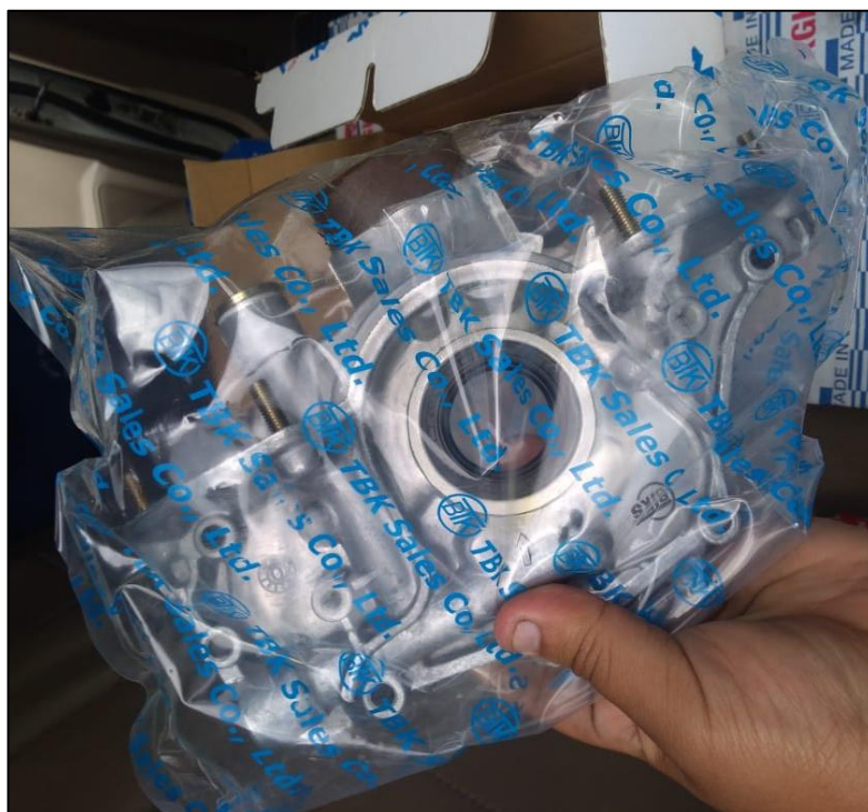
Figura AVI.2 Bomba de agua
