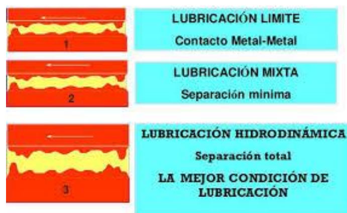
Figura 1.6 Lubricación mixta. Fuente: ( lubricante , 2015)
