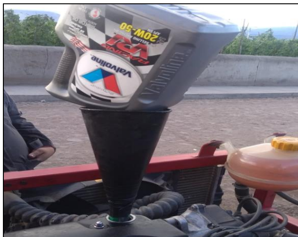
Figura 2.9 Colocación del aceite 20W-50
