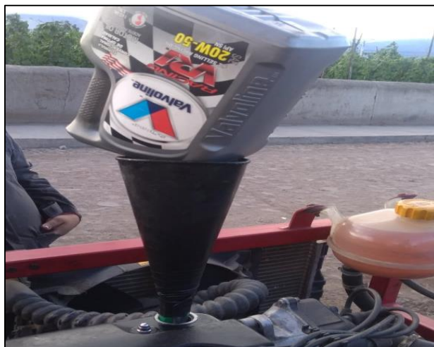
Figura 2.6 Colocación del aceite 20W-50
