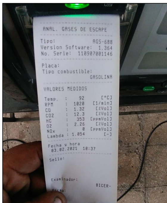
Figura AVIII.2 Datos obtenidos del analizador de gases
