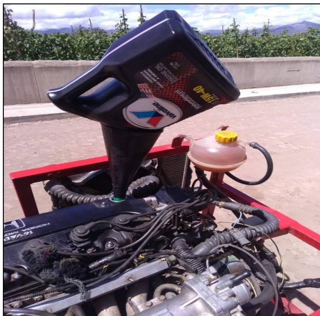
Figura 2.5 Colocación del aceite 15W40
