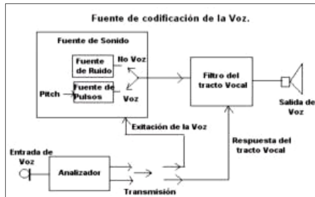
Figura 4.2 Modelo del sistema generador de Voz
