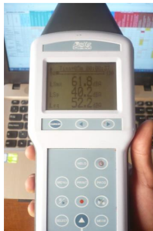
Figura 19 Continuación medición de riesgo físico sonómetro
