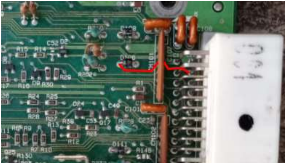
Figura 3.58 Circuito del pin #21 del Socket C
