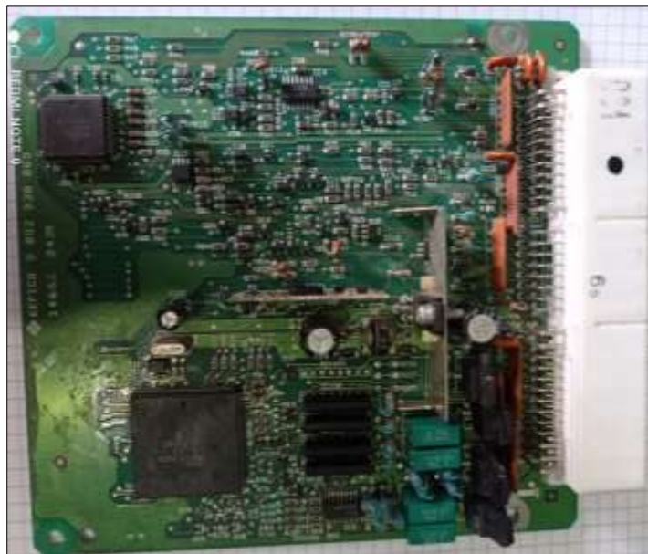
Figura 3.17 Circuito de la computadora del Hyundai Accent 1994
