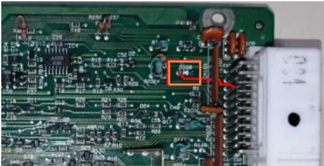
Figura 3.60 Circuito del pin #21 sin diodo
