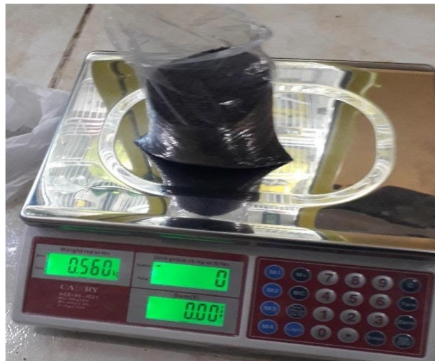
Figura 10. Pesaje de la muestra de suelo para el análisis de N mineral
