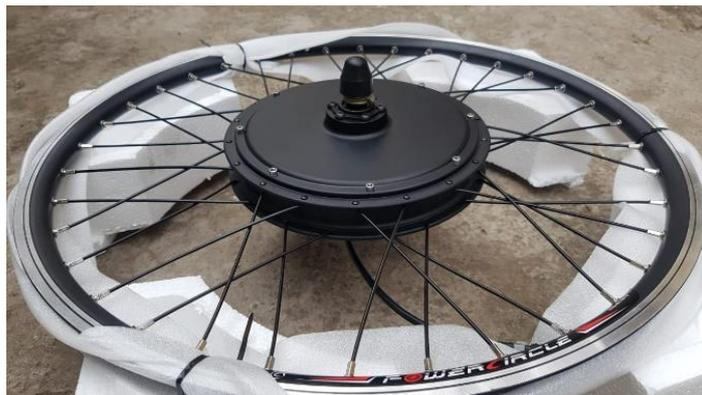
**Figura 2.1** Motor de cubo sin escobillas
