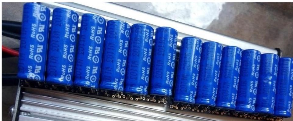
**Figura 2.8** Módulo de supercondensadores
