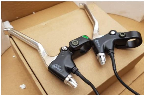
**Figura 2.5** Palancas de freno electrónicas
