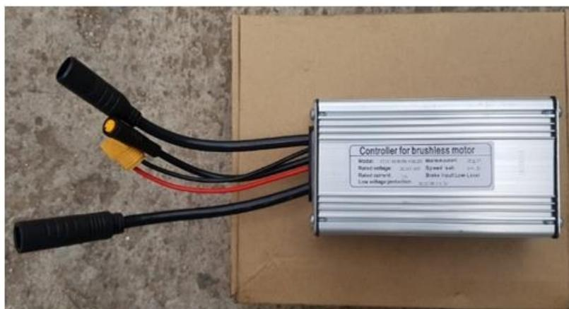
**Figura 2.2** Controlador electrónico
