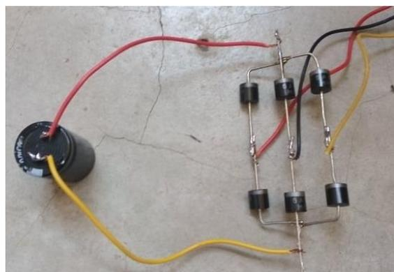
**Figura 2.19** Puente rectificador
