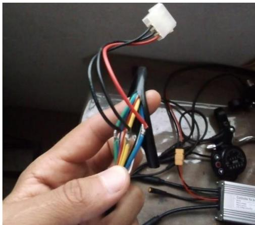
**Figura 2.18** Conexiones de cables de fase
