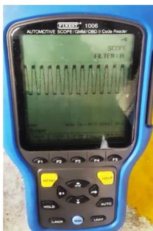
**Figura 2.22** Señal de fase producida por el generador
