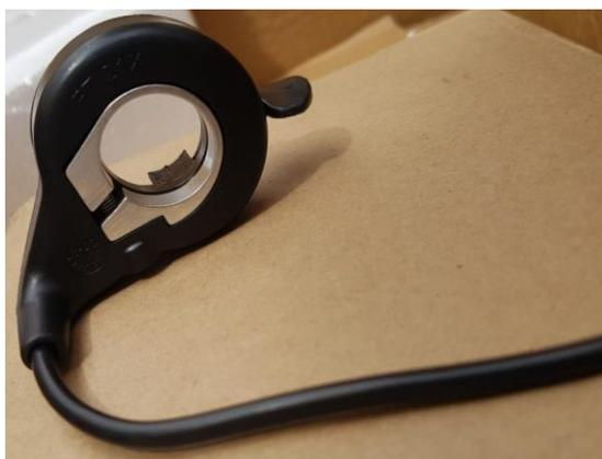
**Figura 2.3** Acelerador de pulgar
