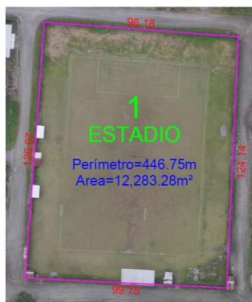
Figura 5. Datos Obtenidos con el Método Ortofotografía
