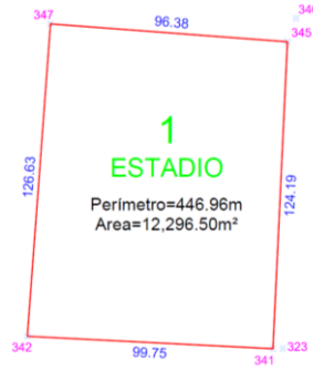
Figura 11. Datos Obtenidos con el Método Estación Total
