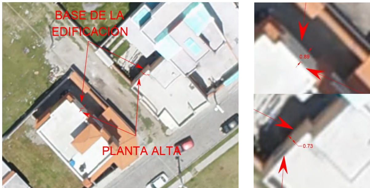
Figura 12. Error de Verticalidad Cantón Cotacachi
