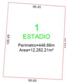
Figura 7. Relevamiento Predial con el Método Cinta Métrica
