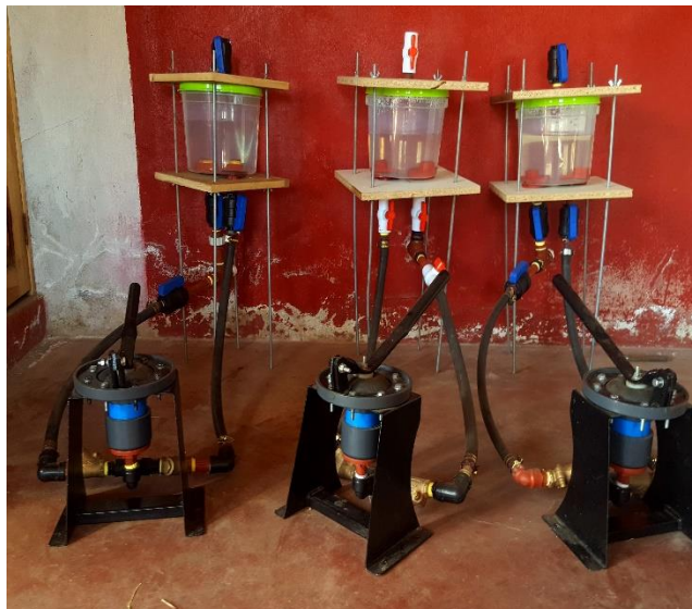
Foto 12. Construcción de digestores batch
