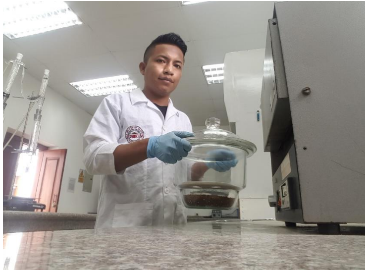
Foto 5. Ingreso de las muestras al desecador y a la mufla
