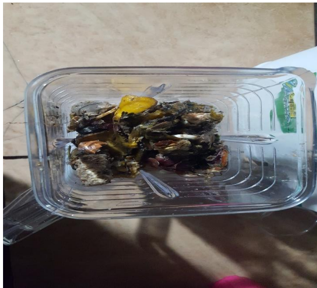
Foto 10. Trituración de la muestra para lectura de pH
