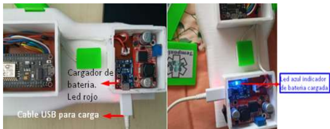
Ilustración 83 Test de batería
