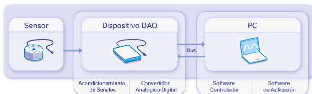
Ilustración 1 Partes de un sistema DAQ
