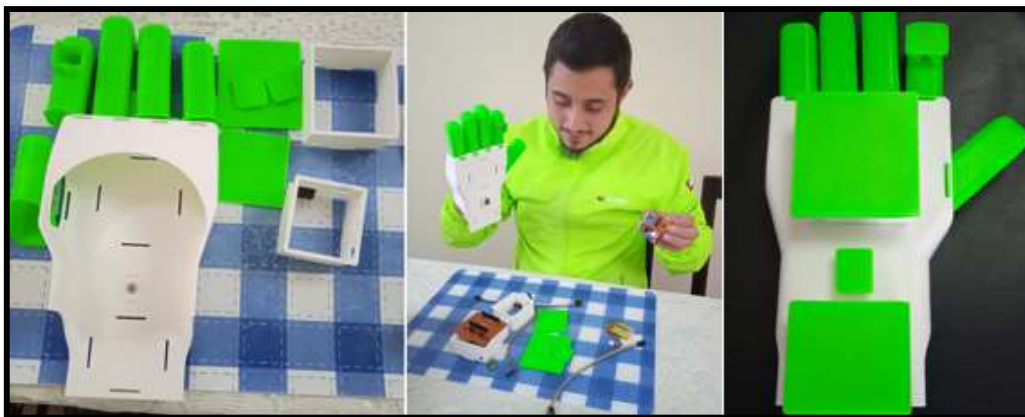
Integración de la placa de desarrollo, módulo de batería y sensores en estructura del guante.
