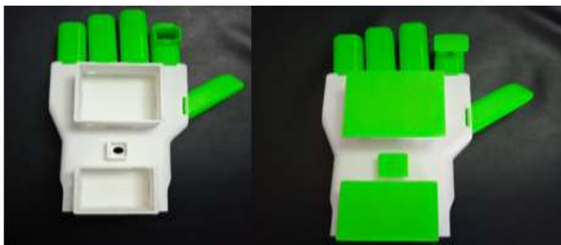
Ilustración 56 Impresión de estructura externa de Tempoxi-19 en TPU y ABS
