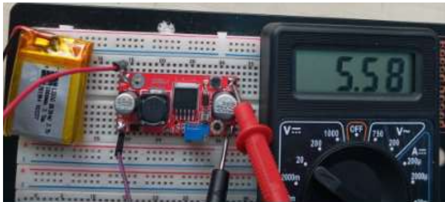
Ilustración 74 Verificación de voltaje de salida regulada del elevador XL6009
