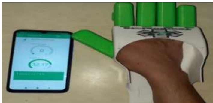
Ilustración 123 Dispositivo Tempoxi-19 y resultados en aplicación Blynk
