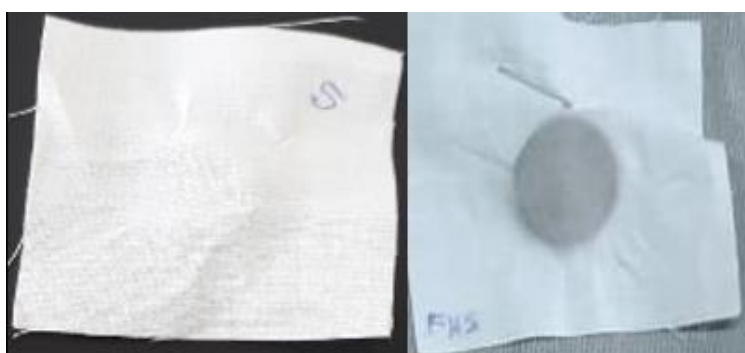
Figura 25. Muestra 5 al 25% tinturada antes y después de la prueba al frote en húmedo
