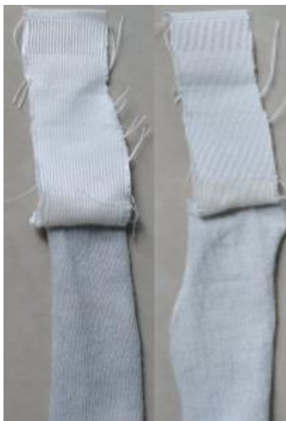
Figura 22. Muestra 2 al 10% Tinturada antes y después de la prueba de lavado.
