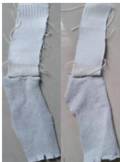
Figura 23. Muestra 3 al 15% tinturada antes y después de la prueba de sudor.
