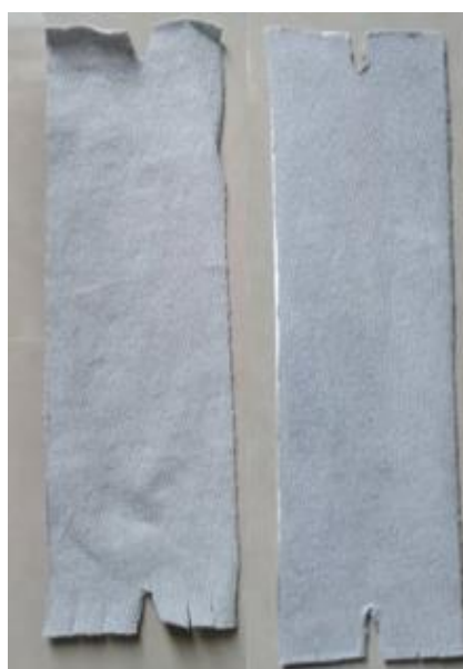
Figura 24. Muestra 4 al 20% tinturada antes y después de la prueba a la luz.
