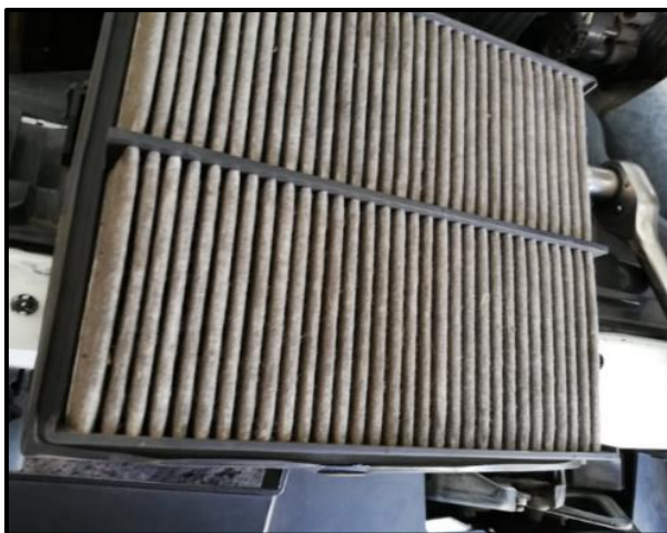
Figura 3.1 Estado del filtro de aire
