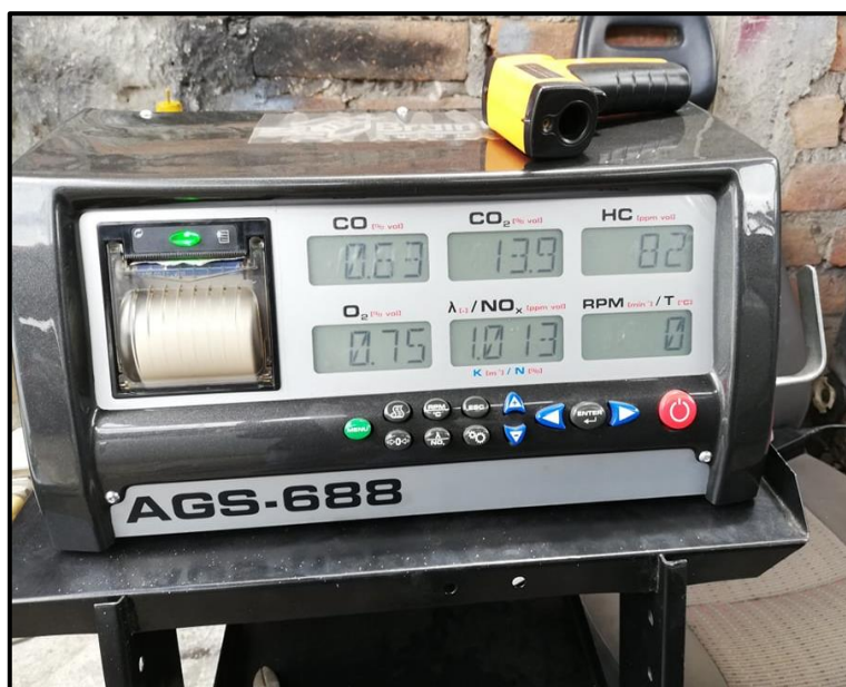
Figura AV.2. Resultados de emisiones antes de regeneración del catalizador Mazda BT50 (2500rpm).
