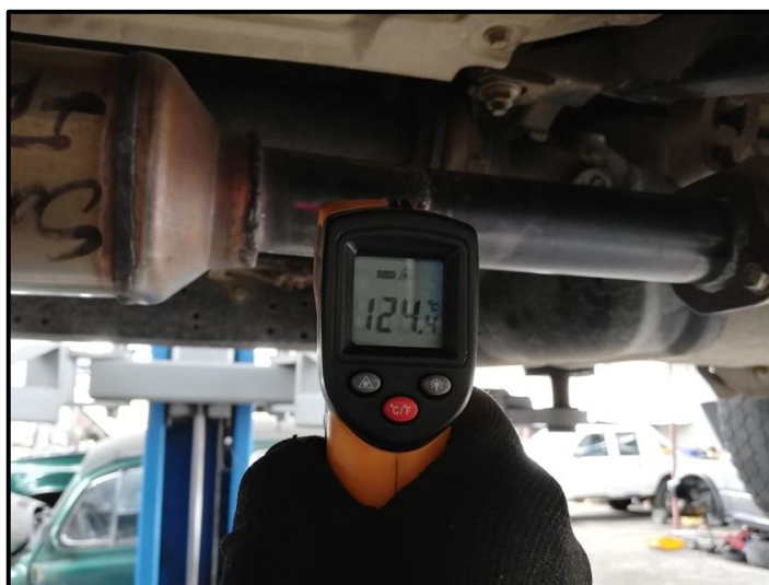
Figura 2.6 Medición de temperatura con termómetro infrarrojo
