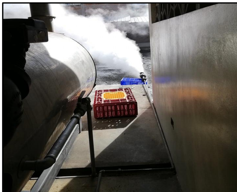
Figura AVII.1. Regeneración del catalizador mediante vapor de agua saturado
