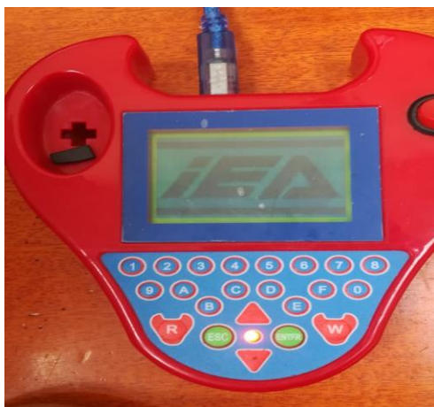
Figura 28 Lectura del transponder con Mini Zed Bull
