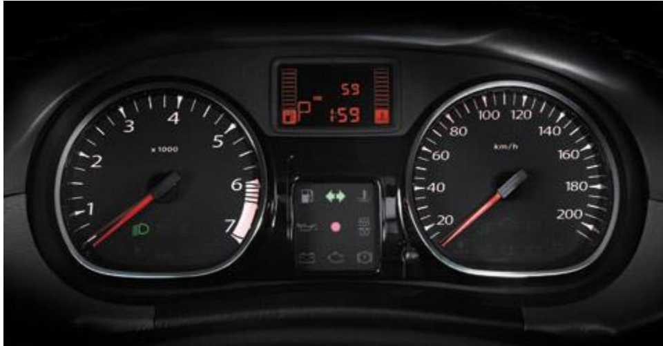
Figura 70. Panel de instrumentos encendido.
