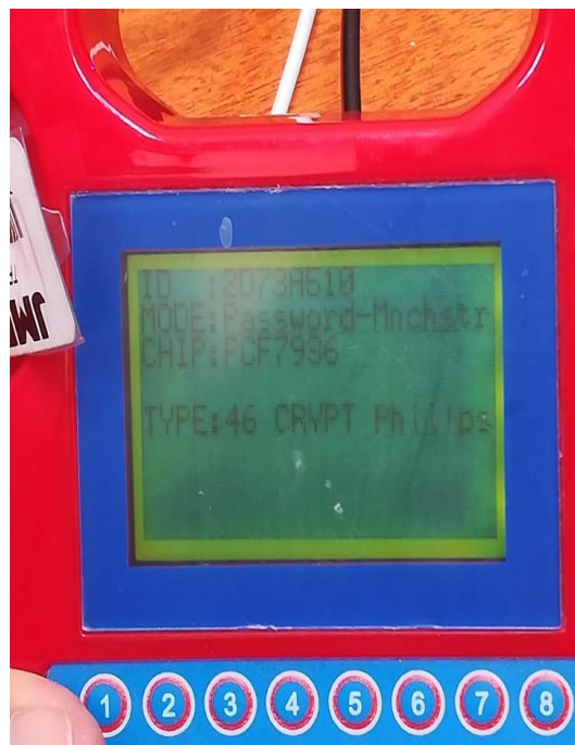
Figura 30 Identificación del Transponder
