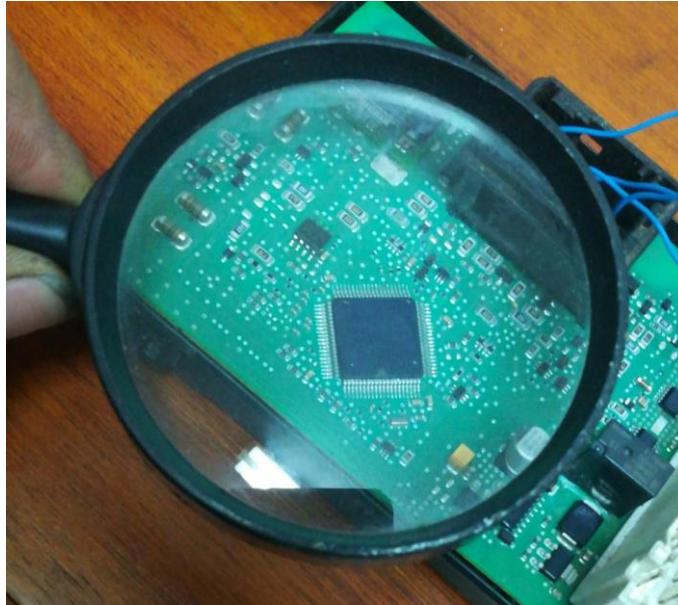
Figura 37 Identificación Micro controlador
