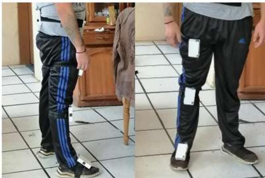
*Figura 91 Posicionamiento de módulos inerciales. (Fuente propia)*
