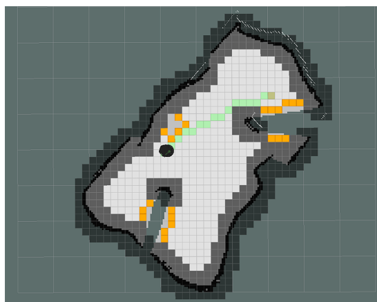
Figura 2.8: Funcionamiento del algoritmo SLAM
