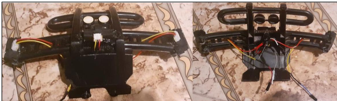
Fig. 34. Montaje de los sensores de distancia Sharp
