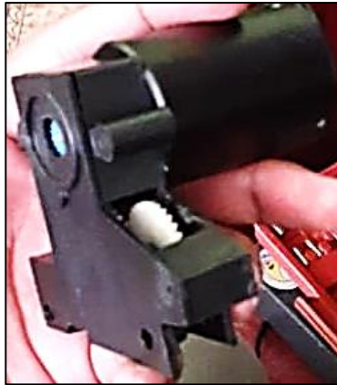
Fig. 31. Motorreductor de 4 engranes Fuente. Autoría propia
