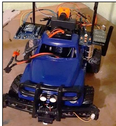
Fig. 40. Montaje del transmisor TS832 de video Fuente. Autoría propia
