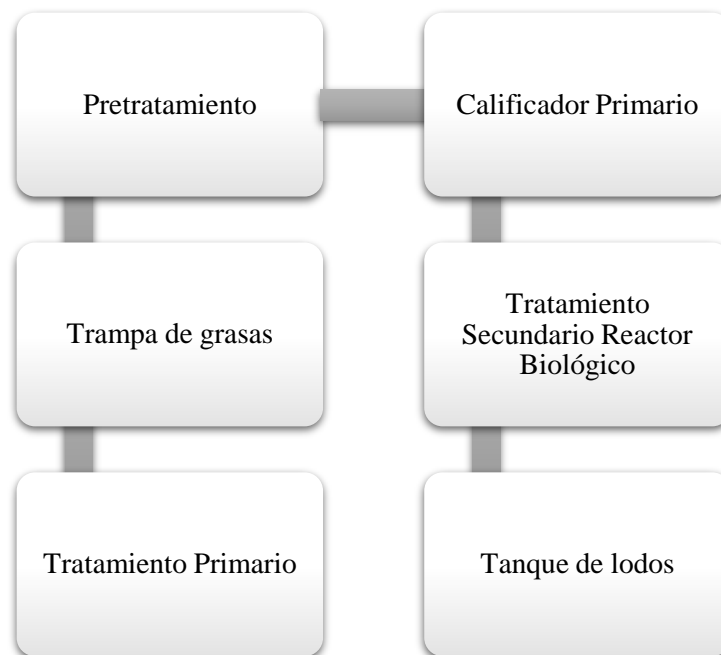
Figura 3. Procesos de la planta de tratamiento de aguas residuales.
