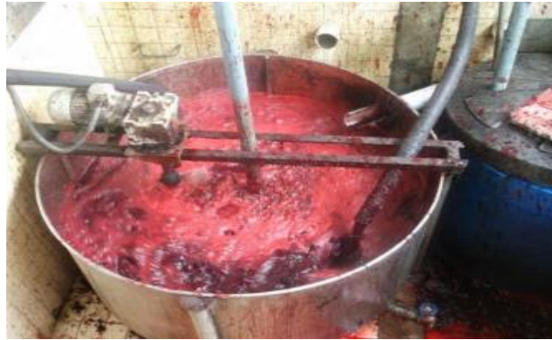
Figura 8. Máquina para el desfibrinado de la sangre con las aspas
