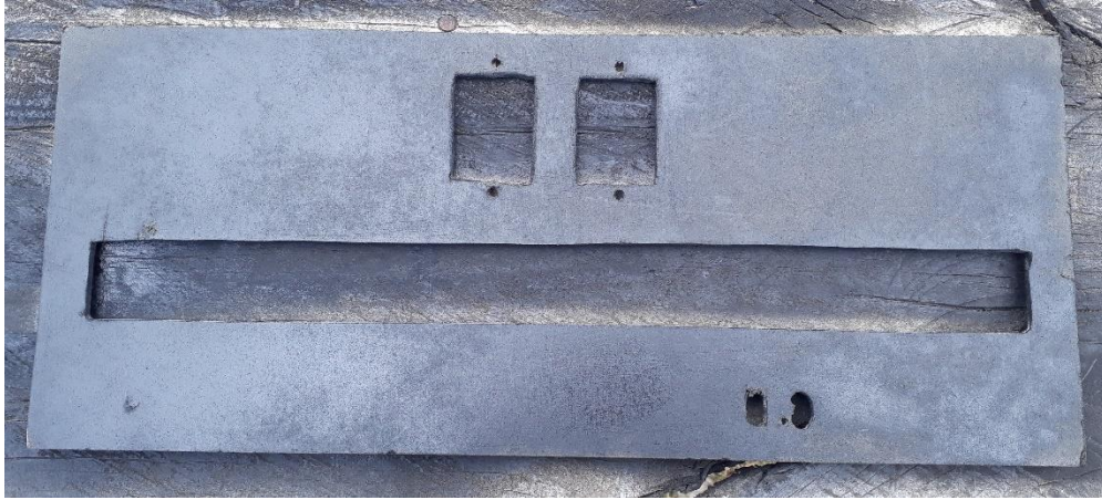
Figura 56: Pintado de la tapa de la carcasa
