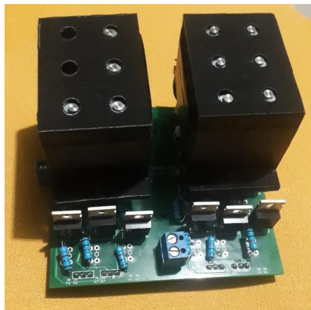
Figura 45: Tarjeta del módulo de escritura con sus componentes soldados
