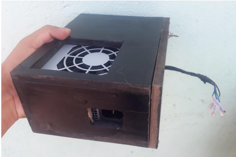
Figura 58: Ensamblaje de la carcasa en la fuente
