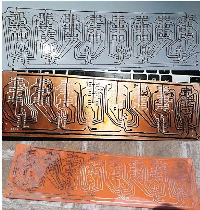
Figura 48: Proceso de construcción de la tarjeta para el módulo de escritura
