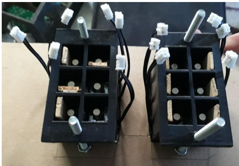
Figura 59: Atornillado de los solenoides a la tapa de la carcasa
