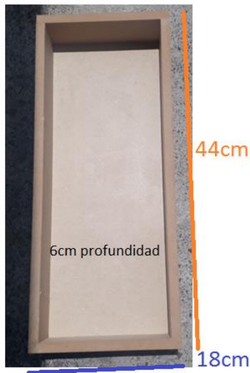
Figura 53: Carcasa rectangular y sus dimensiones
