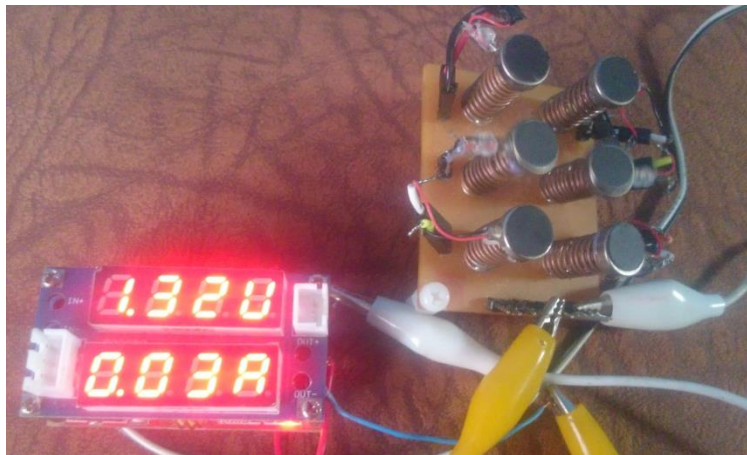
Ilustración 7 Medición de corriente y voltaje de un punto del signo generador
