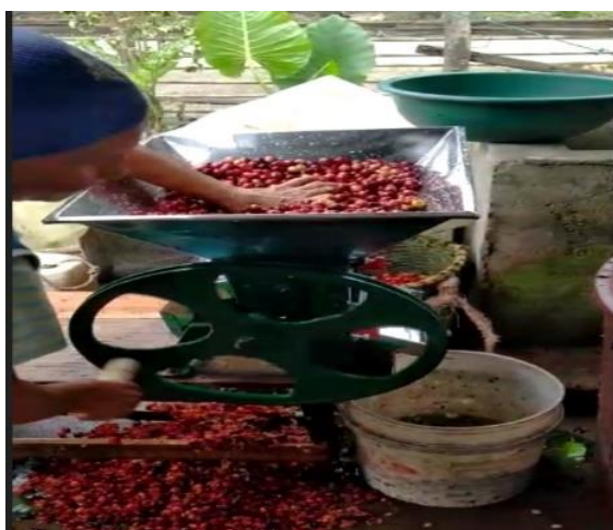
Figura 27. Despulpado del cerezo del café por acción mecánica
