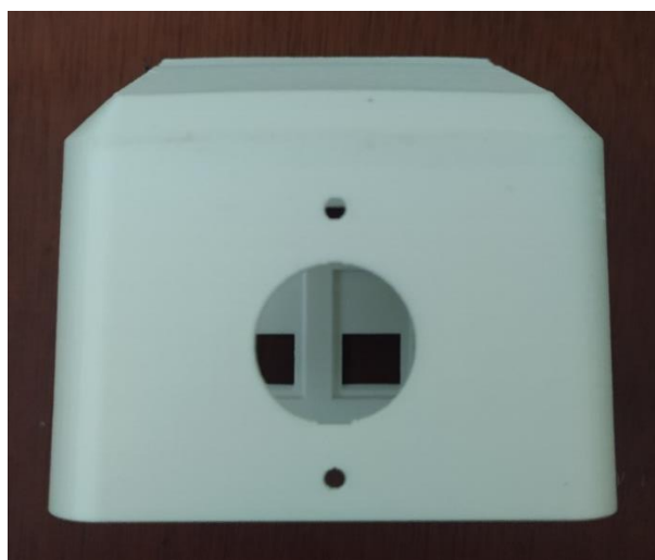
Figura 51 Vista inferior de la impresión 3D de la carcasa
