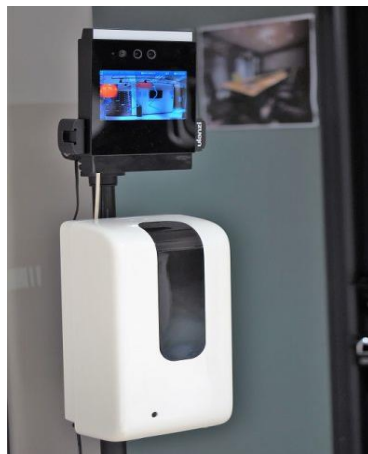
Figura 5 Sistema de reconocimiento facial autónomo, detección de temperatura, y estación de desinfección [6]
