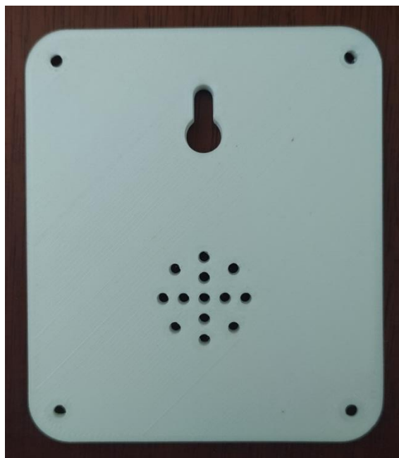
Figura 55 Impresión 3D de la tapa de la carcasa
