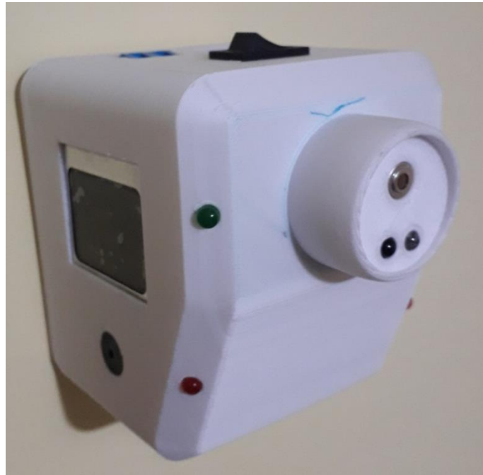
Figura 56 Ensamble completo entre la carcasa impresa en 3D y los elementos electrónico
