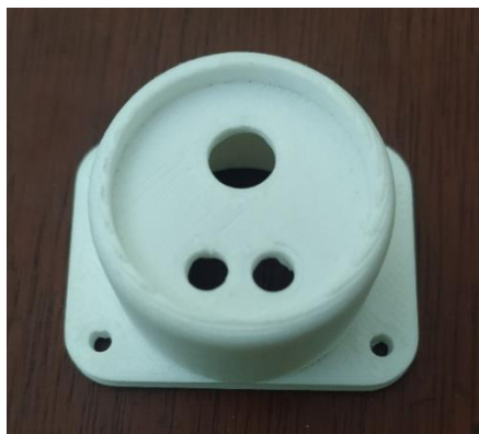
Figura 52 Pieza donde se ubican los sensores de proximidad y de temperatura MLX90614
