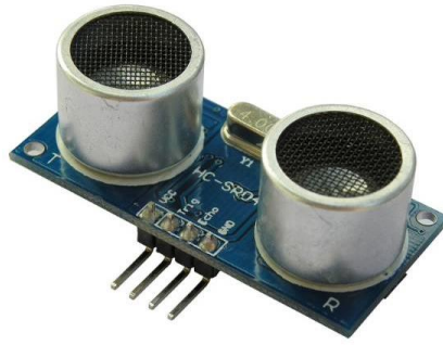
Figura 7 Sensor de Distancia Ultrasónico HC-SR04 [28]
