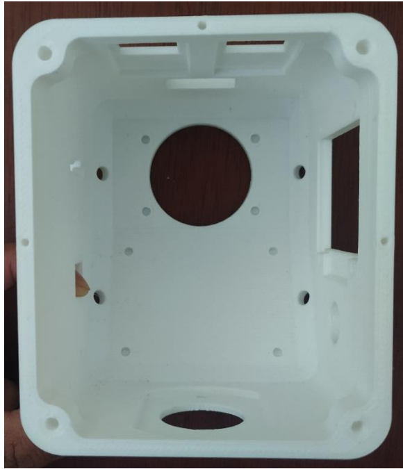
Figura 46 Vista posterior de la impresión 3D de la carcasa
