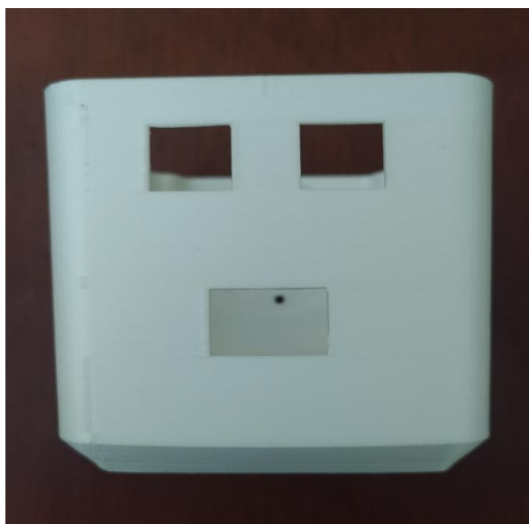
Figura 50 Vista superior de la impresión 3D de la carcasa
