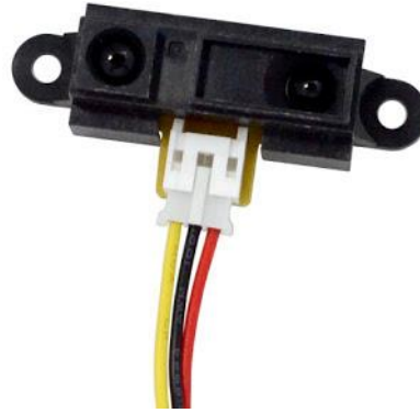
Figura 8 Sensor de distancia infrarrojo GP2Y0A21 [29]
