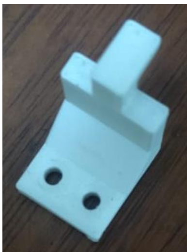
Figura 53 Pieza que soporta el módulo cargador de batería TP4056
