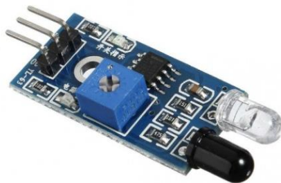
Figura 6 Sensor de proximidad infrarrojo FC-51 [27]
