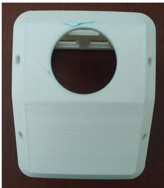
Figura 45 Vista frontal de la impresión 3D de la carcasa
