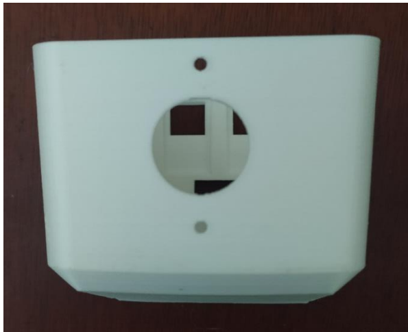
Figura 47 Vista inferior de la carcasa del sistema de medición de temperatura
