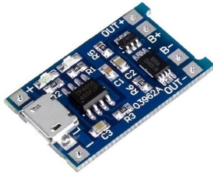
Figura 19 Módulo de Carga y Fuente TP4056 [41]
