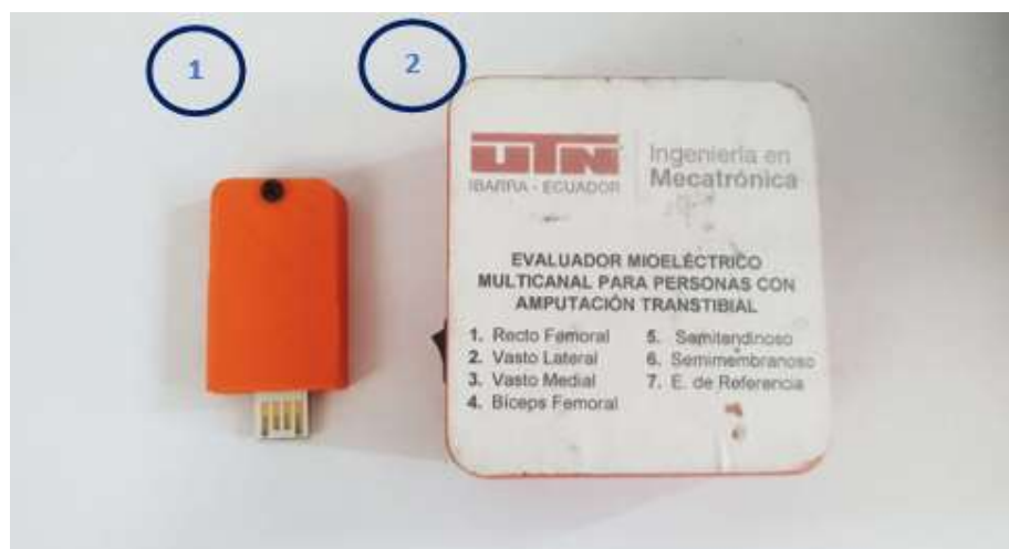
Figura 2.11 Partes de evaluador mioeléctrico multicanal: (1) bluetooth para conexión con ordenador y (2) tarjeta de adquisición de datos.
