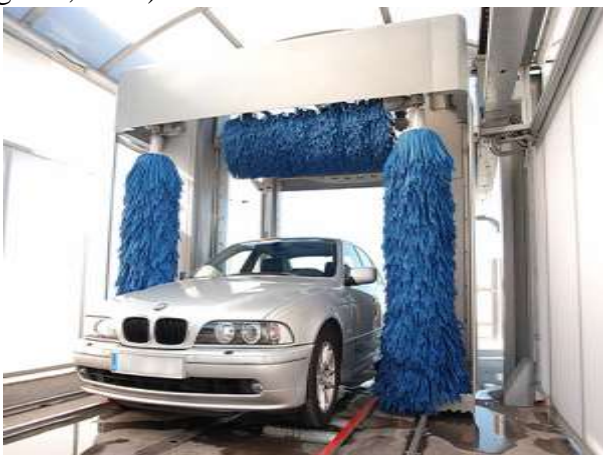
Figura 9. Túnel de lavado
