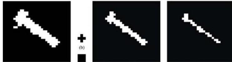
Figura 10 Muestra el operador erosión en una imagen Fuente [12]
