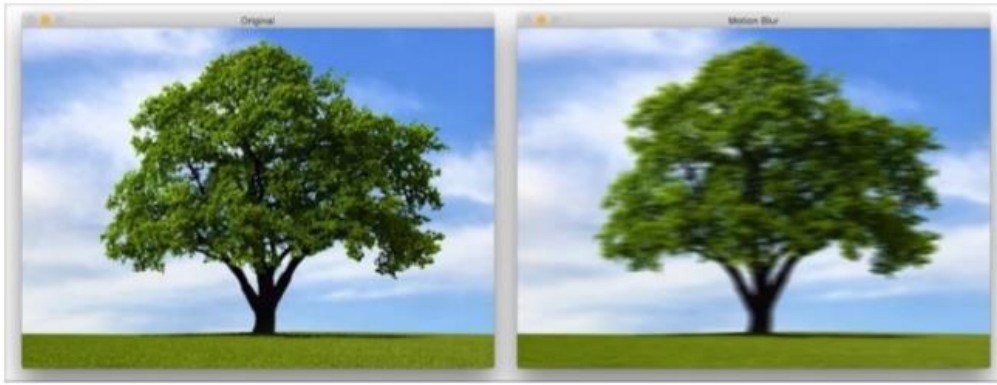
Figura 12 Muestra el operador suavizado en una imagen
