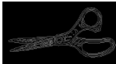
Figura 85 Muestra el operado canny en una imagen Fuente [12]
