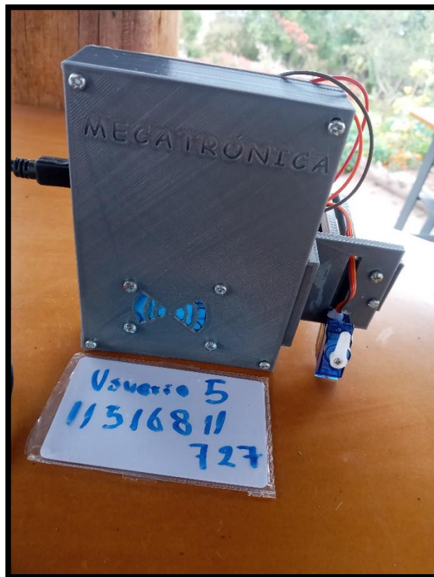
Figura 288 Servomotor ON activado por la Tarjeta RFID
