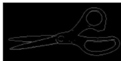
Figura 96 Muestra el operador sobel en la imagen Fuente [12]
