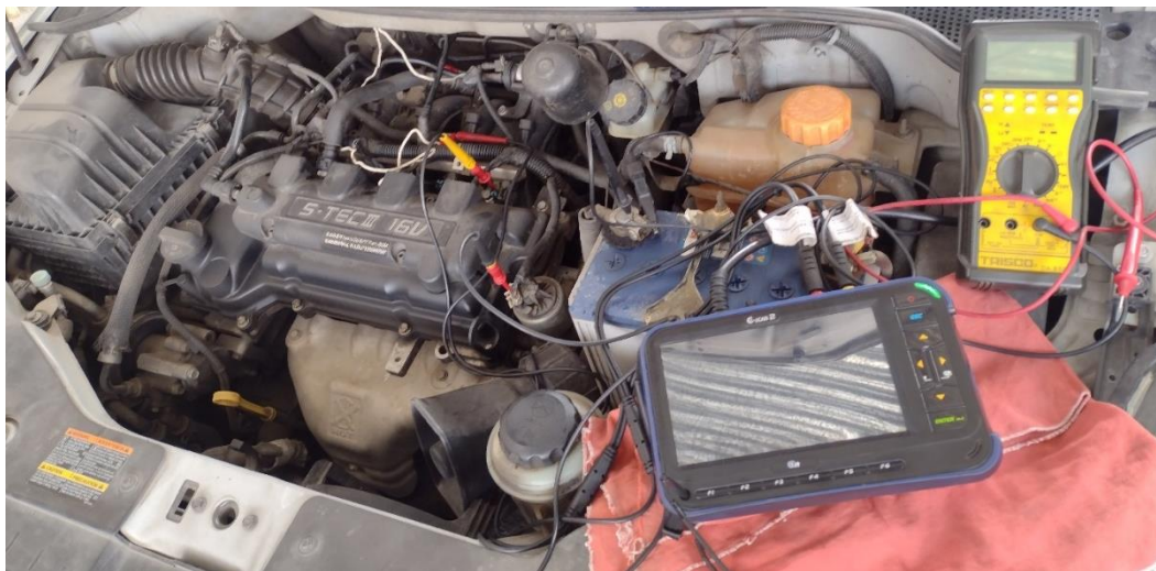
Fig.AV.5 Mediciones eléctricas sobre la válvula EGR, Inyectores y sensor MAP
