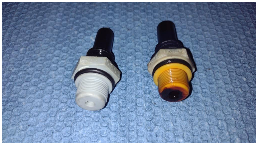
Fig.AIII.3 Estado de las válvulas PCV (Nueva y vieja)
