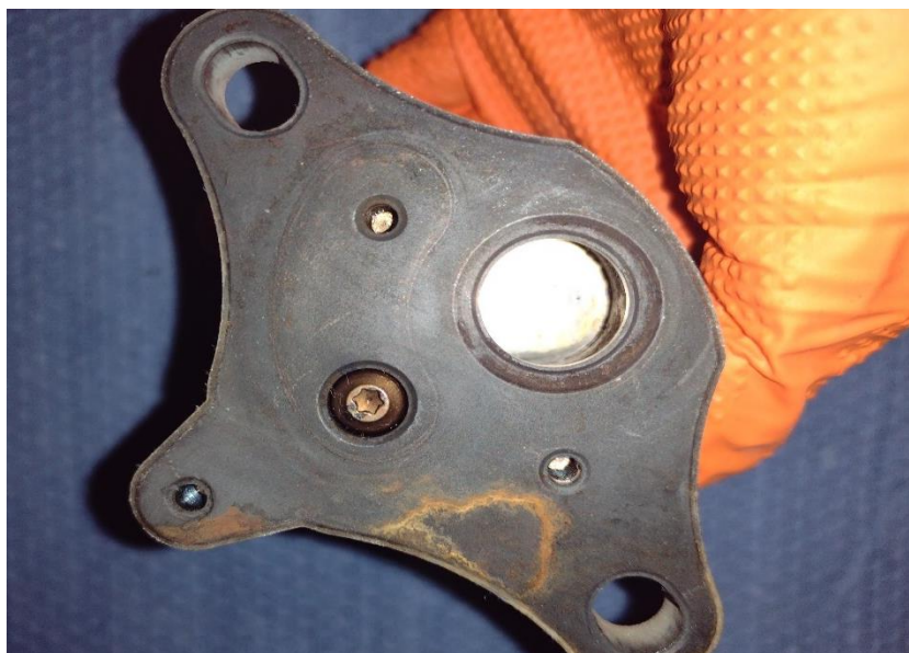
Fig.AIV.4 Estado de la válvula EGR una vez realizada el proceso de limpieza
