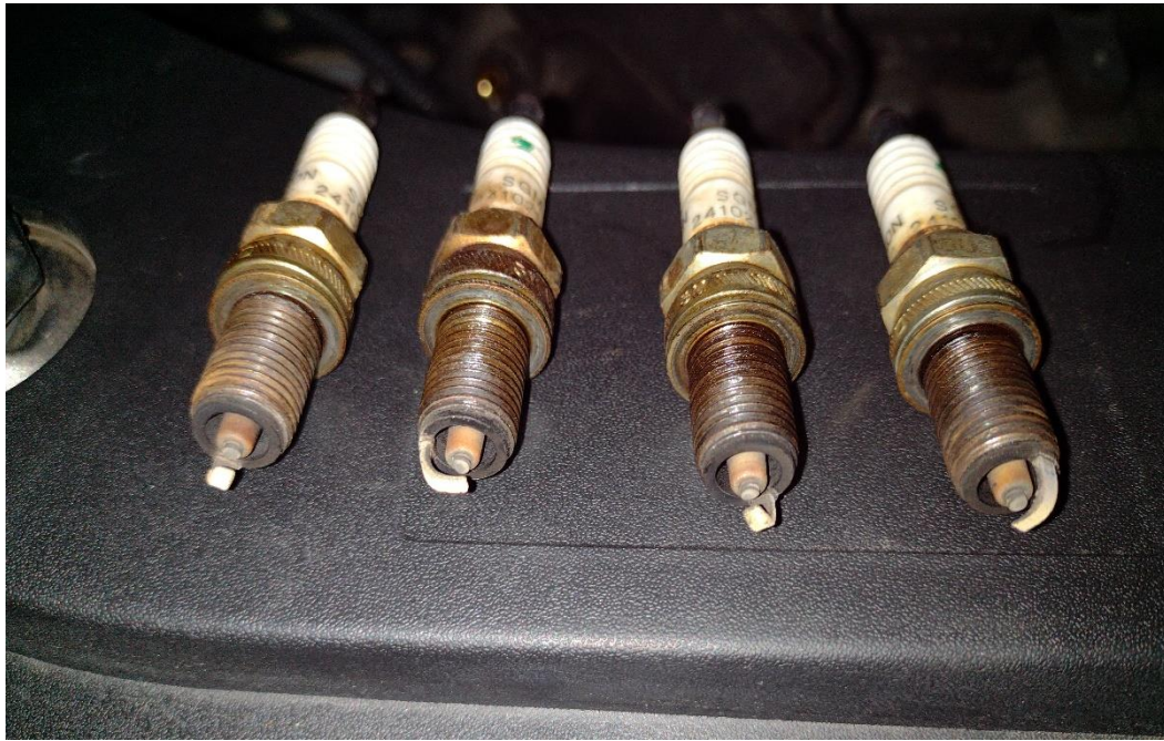
Figura 11 Estado general de las bujías de encendido (Sail 1.4 L)
