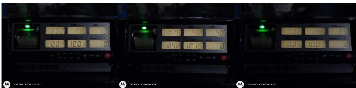
Fig.AII.2 Fotos de los valores mostrados en el analizador Brain Bee AGS-688 durante las pruebas de emisiones
