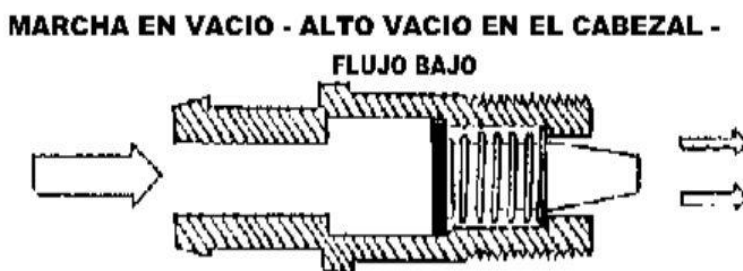
Figura 3 Posición válvula PCV – Bajas revoluciones
