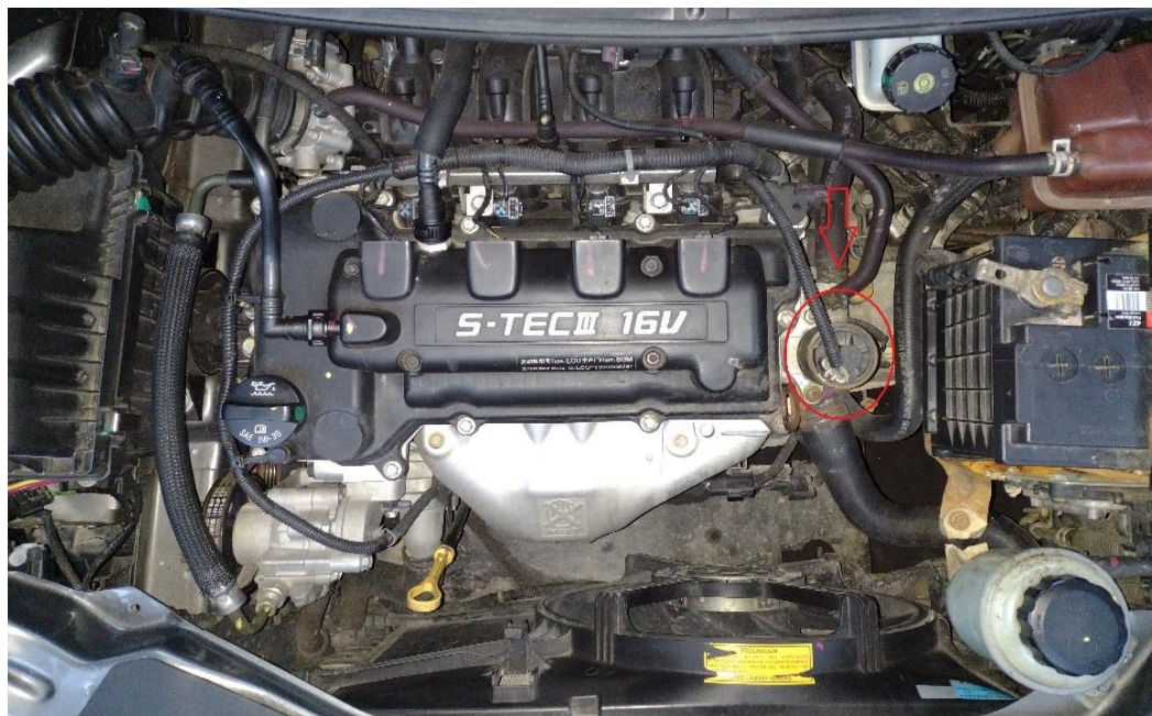
Figura 18 Ubicación de la válvula EGR en el Chevrolet Sail 1.4 L
