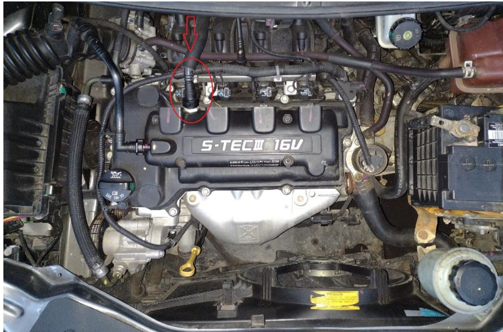
Figura 17 Ubicación de la válvula PCV en el Chevrolet Sail 1.4 L.
