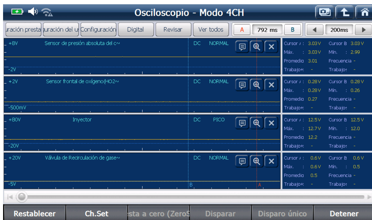
Figura 36 Señal de los sensores e inyector con el motor en KOEO
