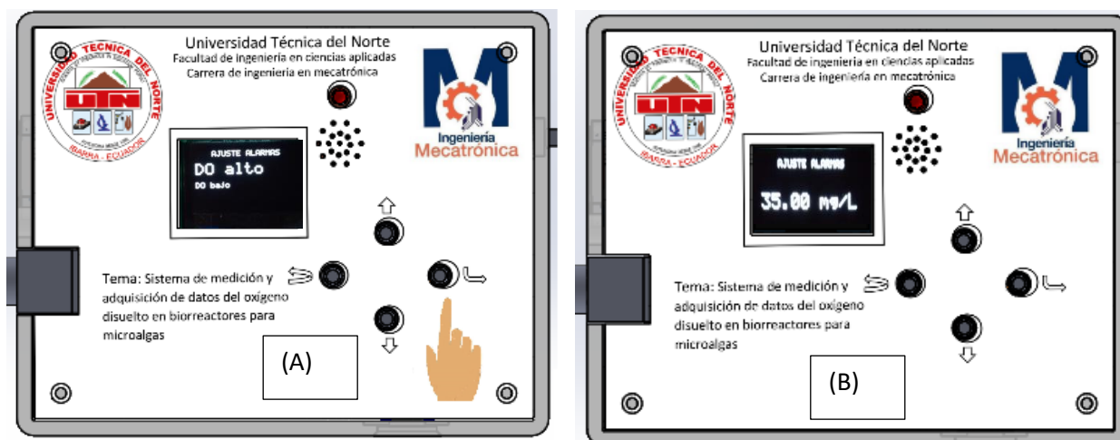
Figura 8. (A) opción de configuración DO alto, (B) valor a configurar de DO alto (Autoría propia.)
