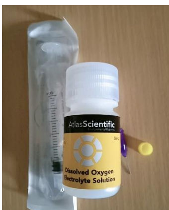
Electrolito de sensor de OD (Autoría propia.)
