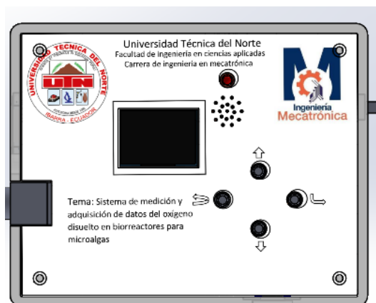
Figura 3. Dispositivo de medición del OD (Autoría propia.)
