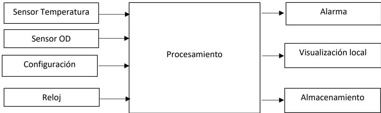
Figura 3. 1. Diagrama de funcionamiento del sistema de medición (Autoría propia.)
