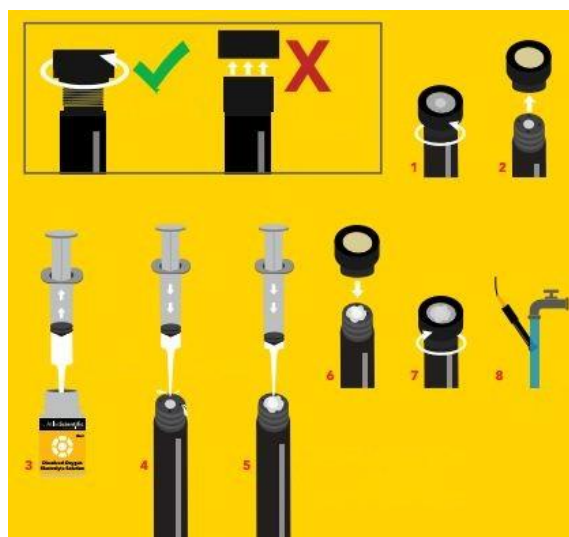
Figura 15. Pasos para introducir solución electrolítica en la sonda (Autoría propia.)
