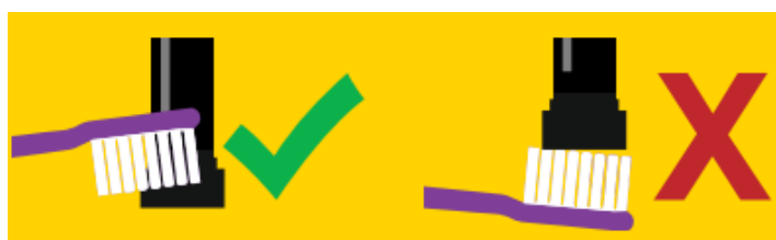
Figura 16. Limpieza correcta del sensor (Autoría propia.)
