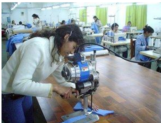
Figura N° 69: Operaria efectuando la actividad de corte.
