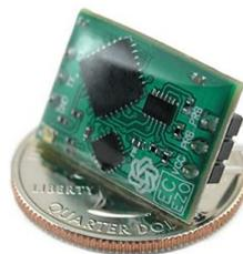
Figura 2.9. Circuito de conductividad embebido [40].
