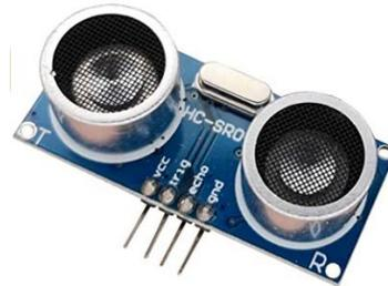
Figura 2.13. Excelity HC-SR04 - Módulo ultrasónico [42].
